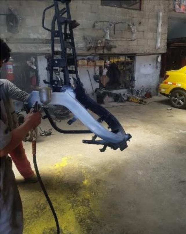
Finalizado el proceso de lijado se realiza el uso de un fondo automotriz que cubra toda la superficie del chasis, este material permite observar fácilmente fallas en la superficie facilitando reconocer los lugares donde sea necesario el uso de macilla o mayor lijado en la superficie, a su vez que tiene la función de ser la primera capa de pintura del color final que tendrá el chasis.
