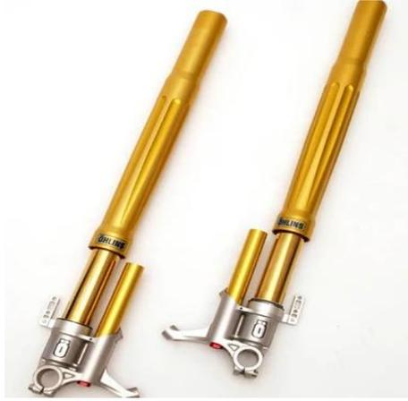
**Telescopios:** La horquilla es telescópica hidráulica y su funcionamiento es similar al ejercido por un pistón y un cilindro, en este caso al pistón se le llama barra y al cilindro botella. La pieza compuesta por dos tubos, que constan a su vez de dos partes, una que se inserta en la otra. La rueda está fijada entre los tubos.
