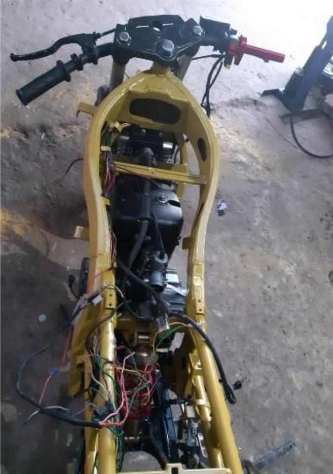
El sistema eléctrico de la motocicleta fue seleccionado en el capítulo anterior, al ser un ramal eléctrico destinado a una motocicleta de calle necesita conexiones para diferentes tipos de elementos inexistentes en la motocicleta construida, como son direccionales, claxon, luces frontales, etc.
