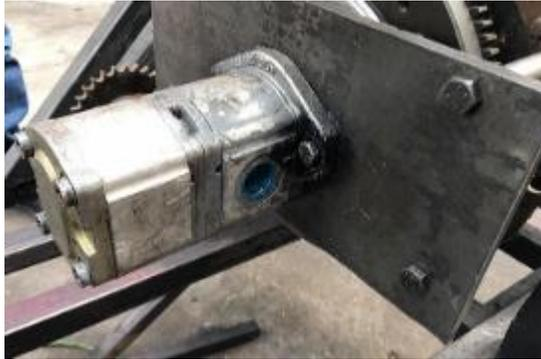
*Nota:* La fotografía muestra el anclaje de la bomba hidráulica
