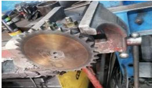
*Nota:* La fotografía muestra el montaje de la catalina en el motor hidráulico
