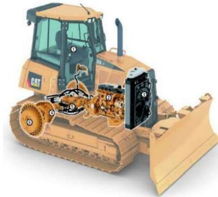
*Nota. Conjunto del tren de potencia de una pala. Tomado de (Herrera, s.f.)*
