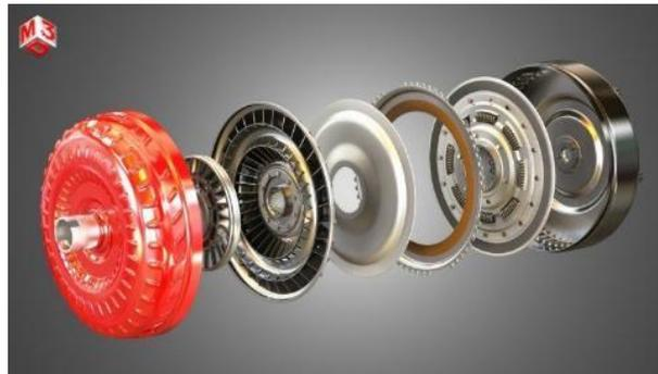
*Nota. Despiece del convertidor par. Tomada de (Turbosquid, s.f.)*
