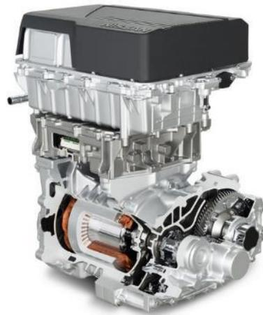
*Nota. Conformación del motor eléctrico. Tomada de (Perez, 2018)*
