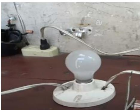
*Nota:* En la imagen se muestra el comprobador de continuidad utilizado para las comprobaciones de los componentes del motor de arranque.
