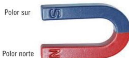
*Nota:* En la imagen se muestra los polos magnéticos tanto como el polo sur y norte de un imán. Tomado de Molina Mengíbar, 2015, pág. 151.
