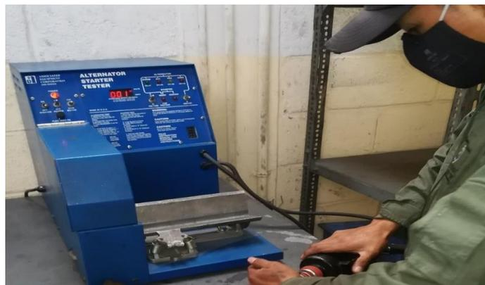
*Nota:* En la imagen se muestra la comprobación del solenoide de arranque para verificar su correcto funcionamiento.
