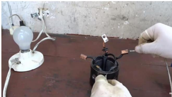
*Nota:* En la imagen se muestra la comprobación de los bobinados de campo del estator que no estén quemados o unidos a tierra o masa.
