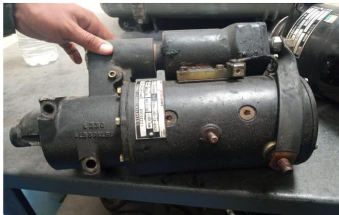
*Nota:* En la imagen se muestra el motor de arranque desmontado del Jeep táctico.
