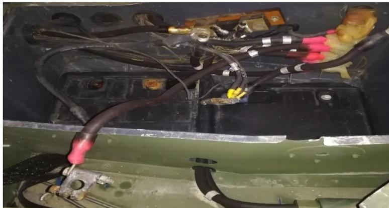
*Nota:* En la imagen se muestra el cable positivo, negativo de las baterías y los cables del TCM del Jeep táctico.
