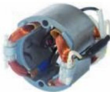
*Nota:* En la imagen se muestra como está conformado el estátor de un motor de arranque. Tomado Sánchez M. IC Editorial 2012, pág. 15.
