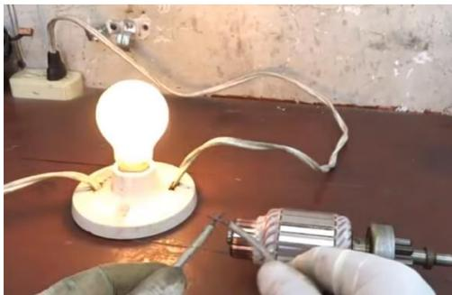
*Nota:* En la imagen se muestra probando la herramienta casera para medir continuidad.
