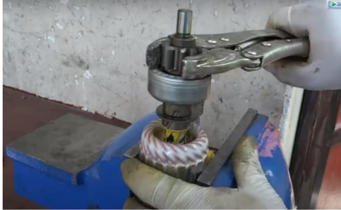
*Nota:* En la imagen se muestra cómo se realiza el giro del piñón de ataque para comprobar que se encuentre en buenas condiciones.
