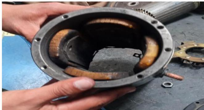
*Nota:* En la imagen se muestra el estator con sus componentes internos.
