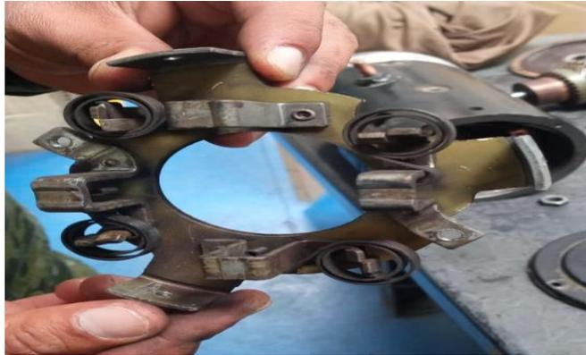
*Nota:* En la imagen se muestra la porta escobillas donde están montadas las escobillas tanto negativas como positivas del motor de arranque.
