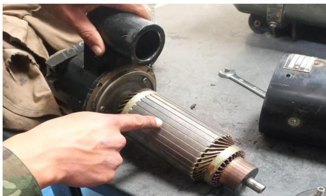
*Nota:* En la imagen se muestra el colector, bobinados y delgas que componen el conjunto del inducido del motor de arranque.
