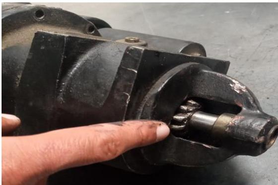
*Nota:* En la imagen se muestra conjunto piñón el mismo que se acopla al volante de inercia para poner en funcionamiento el motor del Jeep táctico.
