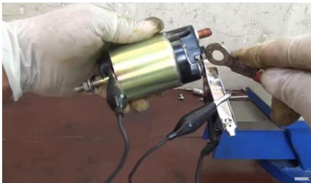
*Nota:* en la imagen se muestra cómo se realiza la conexión de automático para poder comprobar si no está quemado o en corto circuito los bobinados.
