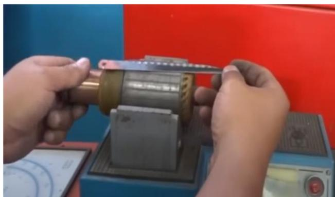
*Nota:* En la imagen se muestra la colocación del inducido en la máquina para probar si los bobinados del inducido no están en corto circuito.
