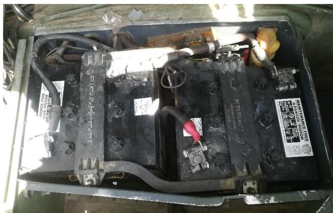
*Nota:* En la imagen se muestra las baterías del Jeep táctico conectadas en serie para obtener 24 voltios.
