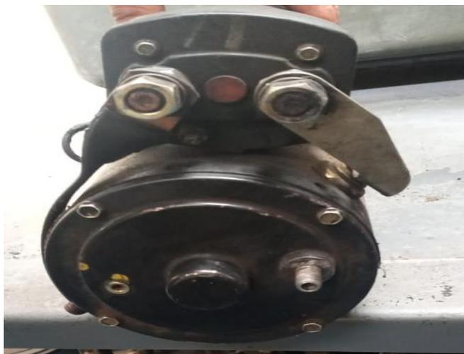
*Nota:* En la imagen se muestra los terminales de conexión del automático y el borne 50 del motor de arranque del Jeep táctico.
