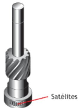
*Nota:* En el gráfico muestra el eje portasatélites y satélites del motor de arranque.
