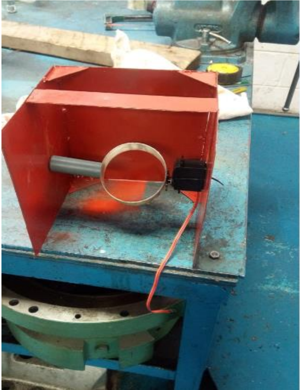
Figura 3 Elaboración de la estructura para insertar botella
