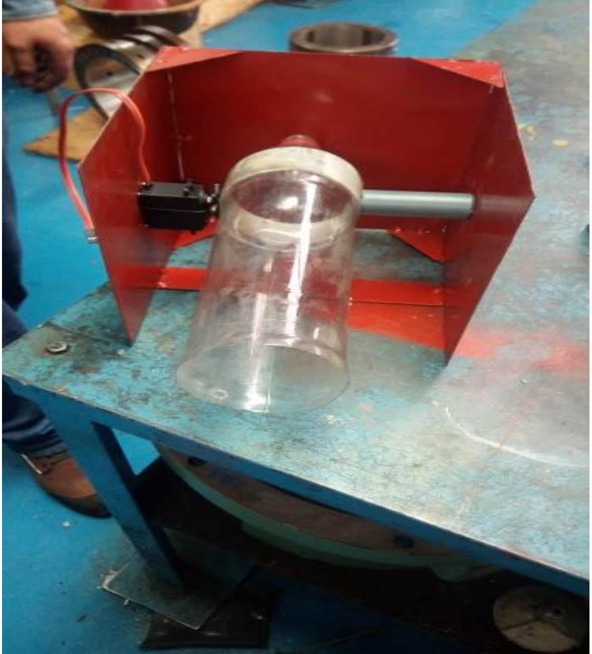
Figura 4 Estructura completa del servomotor
