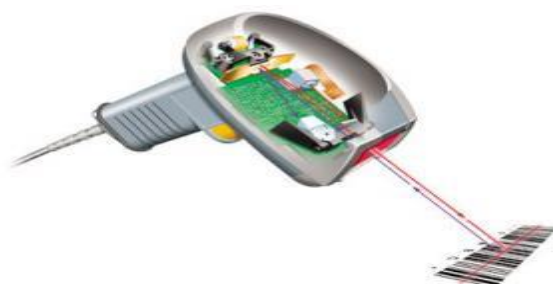
Figura 19 Lector de código de barras, funcionamiento
