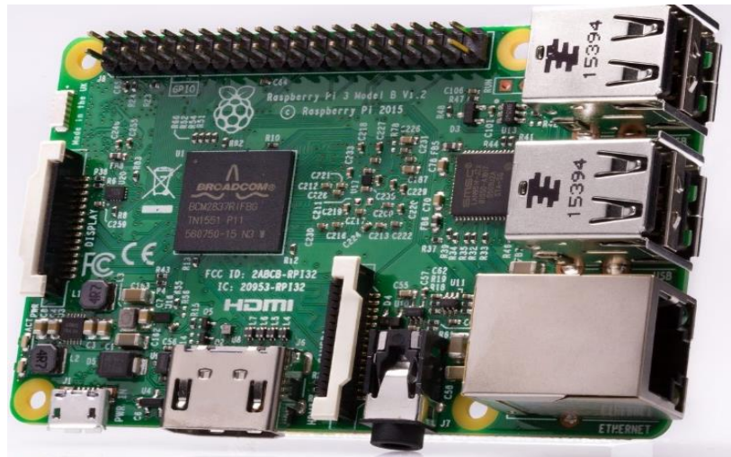
Figura 7 Raspberry Pi es un pequeño ordenador con arquitectura ARM
