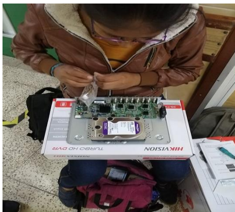
Figura 34. Instalación de Disco Duro Western Digital Purple
