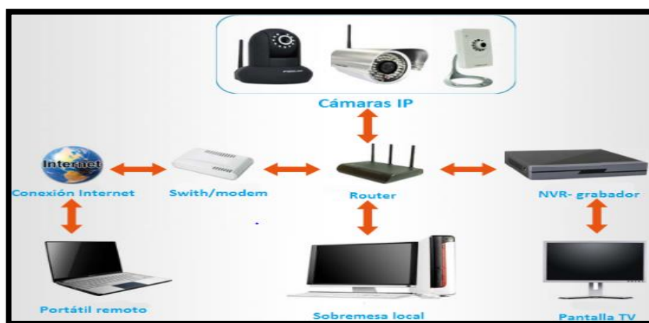
Figura 2. Estructura de un CCTV IP
