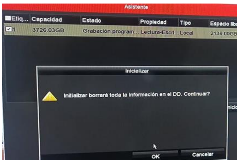
Figura 43. Formateo de Disco Duro
