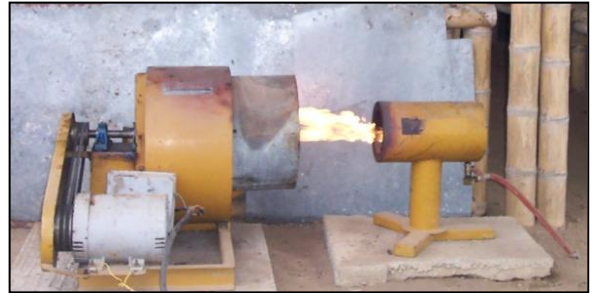
Equipo de secado por flujo de aire caliente Fuente: Luis Ortiz
