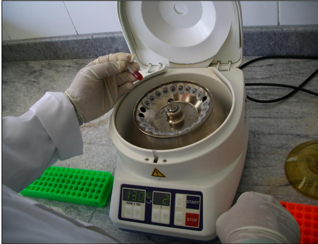
Foto 5.7. Centrifugación de muestras a 13.000 rpm.
