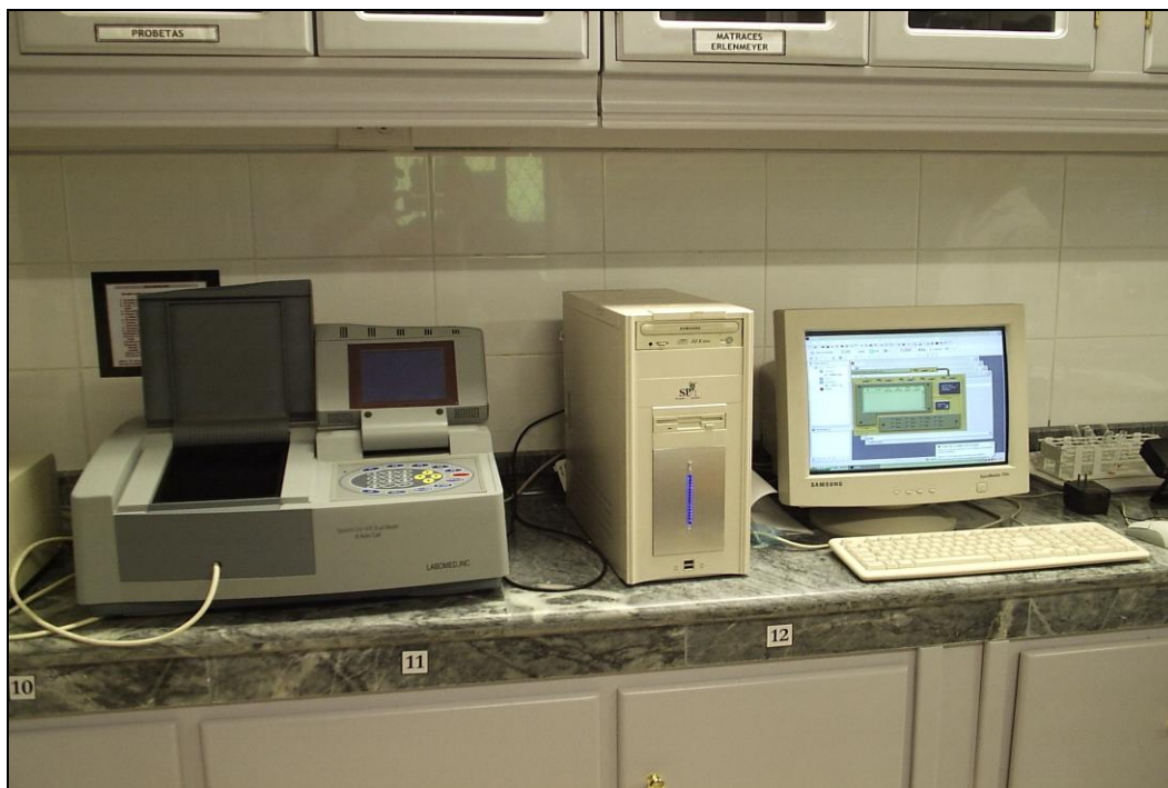
Foto 5.24. Espectrofotómetro (UV-VIS Dual Beam, Labomed INC), para cuantificar ADN bovino.
