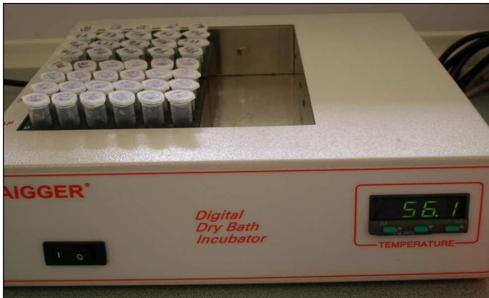
Foto 5.9. Incubación de las muestras a 56° C, para liberar el ADN bovino.
