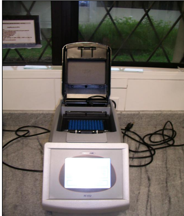
Foto 5.27. Termociclador TECHNE TC-512 2003, utilizado para la incubación de las muestras con la enzima HindIII .
