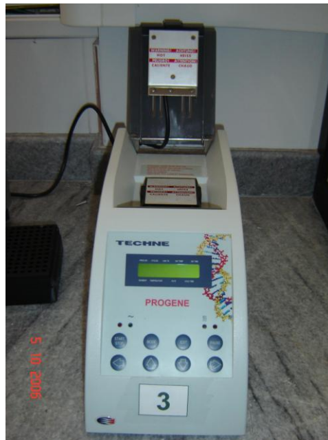
Foto 5.26. Termociclador TECHNE Progene 1999, utilizado para la amplificación del fragmento en estudio.
