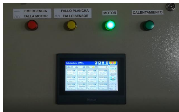
(c) Alarma de fallo de sensor (Tren de pulsos).
