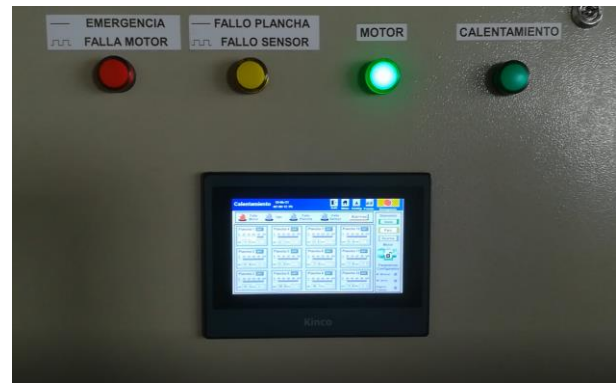
(d) Alarma de fallo de motor (Tren de pulsos).
