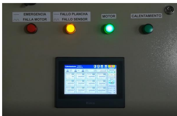
(c) Alarma de fallo de sensor (Tren de pulsos).
