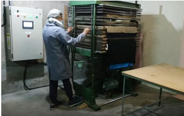
(c) Extracción de los pernos de sujeción y prensado.
