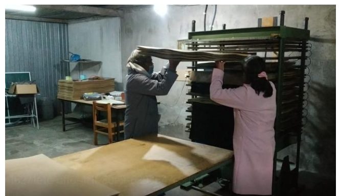
(b) Colocación de los bloques en la máquina.
