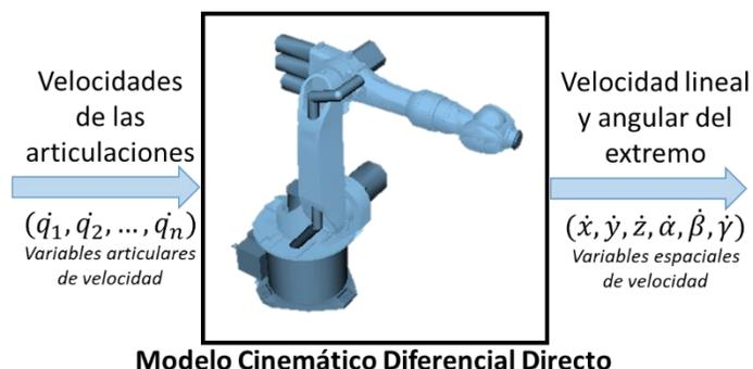
Para el análisis se debe considerar que el aporte que realiza cada articulación del robot tiene una dependencia directa con la posición en un determinado instante de tiempo. El modelo cinemático diferencial implica la obtención de la matriz Jacobiana, de dimensión  $6 \times n$  en la que cada columna se asocia con una de las articulaciones del robot.
