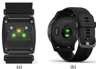
Nota: Sistema de sensado de la señal PPG para los dispositivos (a) Rhythm 24 y (b) VivoActive4. Imágenes adaptadas de *Scosche Rhythm24 Waterproof Heart Monitor Armband*, por Scosche, 2021, Scosche y de *vivoactive® 4 | Smartwatch with GPS | GARMIN*, por Garmin Ltd., 2019, Garmin Ltd.
