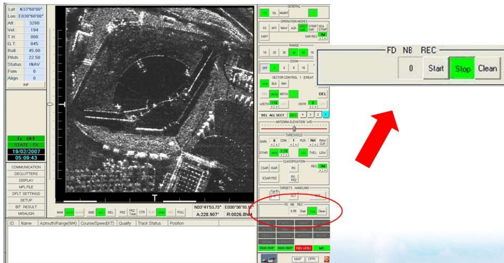
Figura 2.34 Grabación en disco Fuente: Investigación de campo Elaborado por: Cbos. Aguirre David
