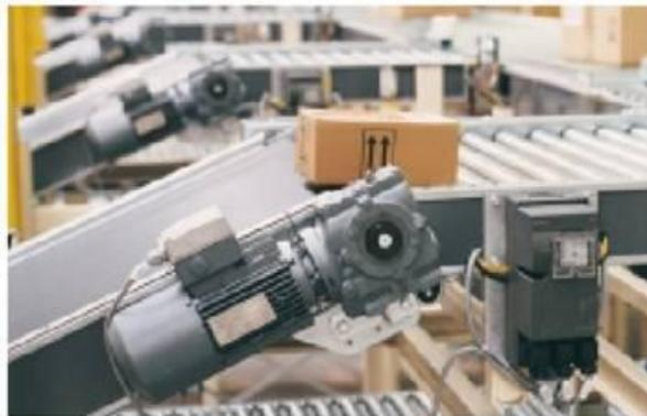
**Figura. 2.3** El arrancador de motor dentro la red AS-Interface.
