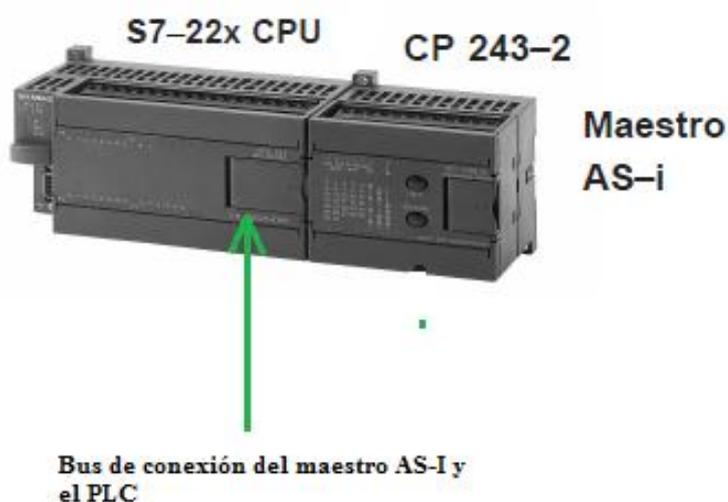
**Figura. 3.1** PLC y módulo maestro AS-i conectados
