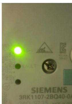
**Figura 3.56** Esclavo AS-I en correcto funcionamiento
