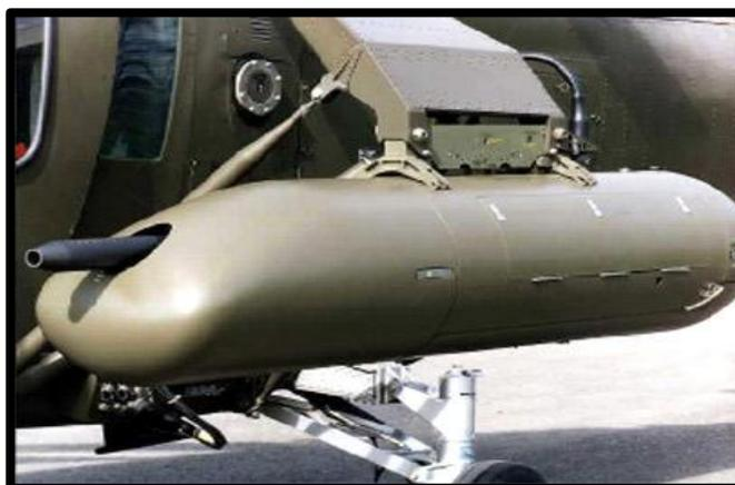
**Figura 10:** Ametralladora HMP-400
