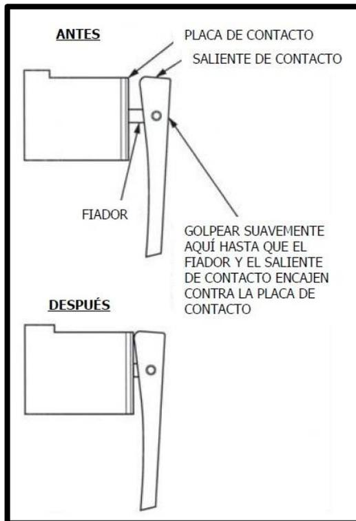
**Figura 2. 15:** Acoplamiento de la traba del reten
