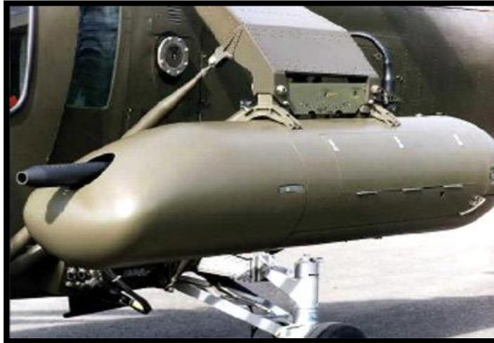
**Figura 2. 27: Ametralladora HMP-400**
