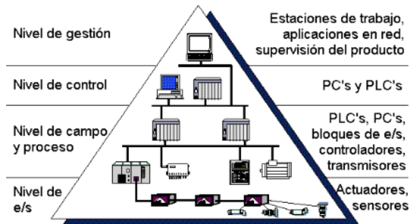
Ilustración 1 Jerarquía de comunicaciones industriales Fuente: http://www.profesores.frc.utn.edu.ar/industrial/sistemasinteligentes
