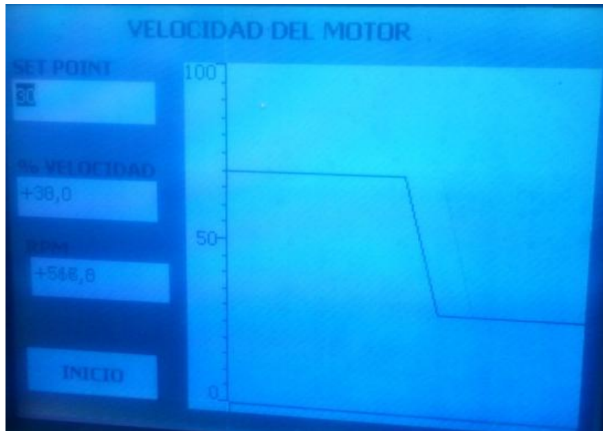
Fotografía 3.7 HMI Interfaz para datos del motor trifásico Realizado por: Paúl Masapanta
