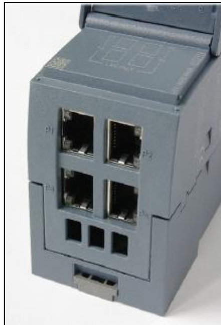
Fotografía 2.4 Conectores hembra RJ45 del Switch CSM 1277 Realizado por: Paúl Masapanta
