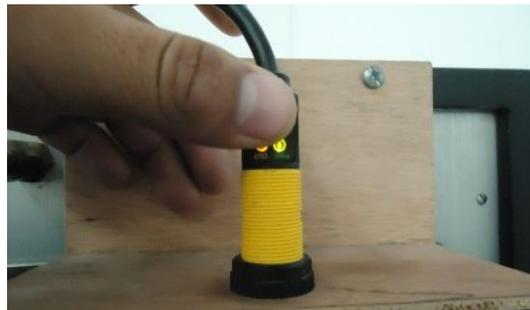
Fotografía 3.12 Calibración del sensor de nivel.
