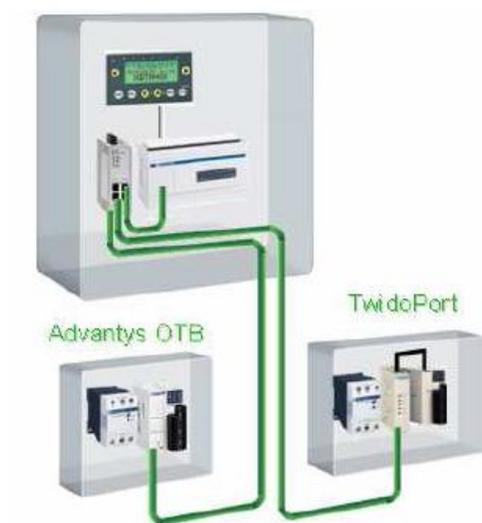
Figura 2.10 Ejemplo de arquitectura Ethernet
