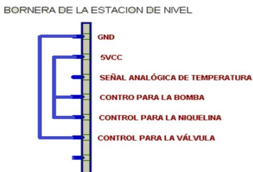
Figura 3.83 Conexión de bornes terminales de la estación de nivel.
