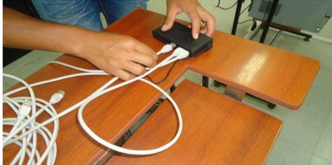
Figura 3.111 Conexión de las PC's al switch.
