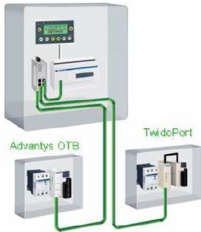
Figura 2.10 Ejemplo de arquitectura Ethernet Fuente: http://www.adtecnologias.com/Catalogos/Manual_Twido.pdf
