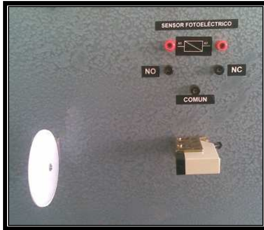
Foto 6.40: Identificación del sensor TELEMECANIQUE Fuente: Laboratorio de Control Industrial Realizado por: Cbos. Sánchez Luis
