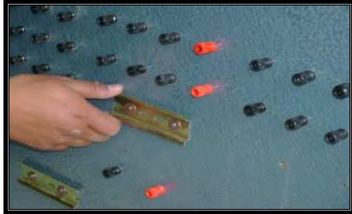
Foto 6.12: Colocación del riel dim Fuente: Laboratorio de Control Industrial Realizado por: Cbos. Sánchez Luis
