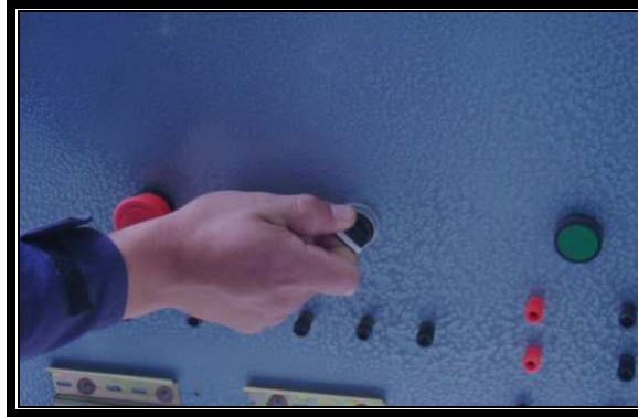
Foto 6.16: Colocación del selector Fuente: Laboratorio de Control Industrial Realizado por: Cbos. Sánchez Luis
