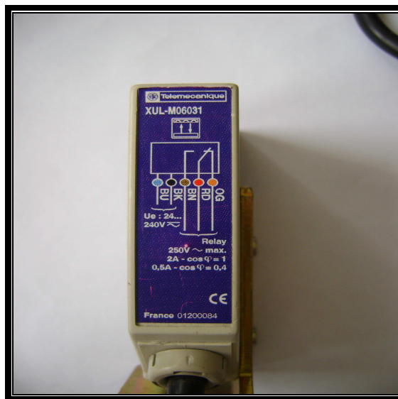
Foto 6.43: Especificaciones del sensor fotoeléctrico Fuente: Laboratorio de Control Industrial Realizado por: Cbos. Sánchez Luis
