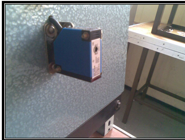
Foto 6.25: Montaje del sensor SASSIN Fuente: Laboratorio de Control Industrial Realizado por: Cbos. Sánchez Luis
