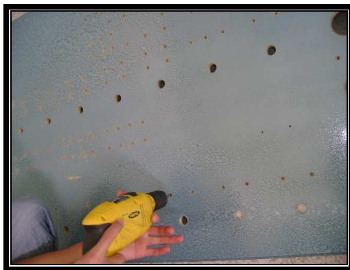
Foto 6.8: Perforación del tablero Fuente: Laboratorio de Control Industrial Realizado por: Cbos. Sánchez Luis
