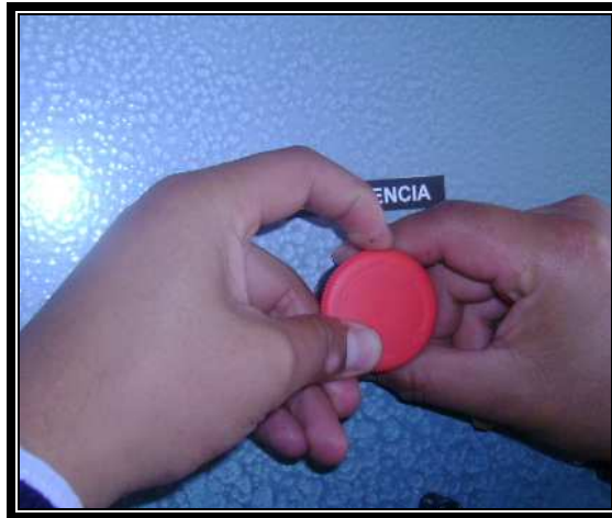
Foto 6.15: Colocación del paro de emergencia Fuente: Laboratorio de Control Industrial Realizado por: Cbos. Sánchez Luis
