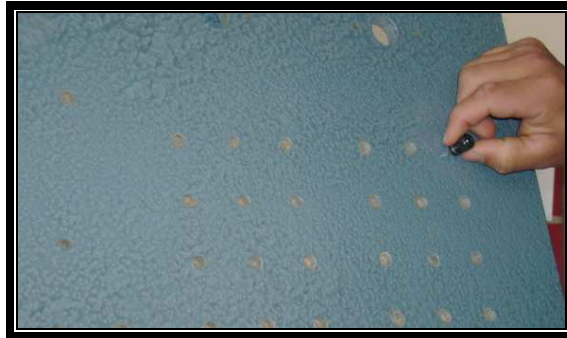
Foto 6.10: Colocación de los jacks Fuente: Laboratorio de Control Industrial Realizado por: Cbos. Sánchez Luis
