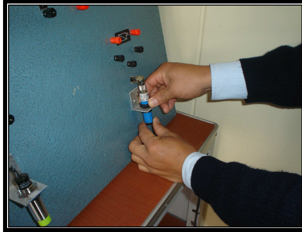
Foto 6.24: Montaje de sensores cilíndricos SASSIN Fuente: Laboratorio de Control Industrial Realizado por: Cbos. Sánchez Luis
