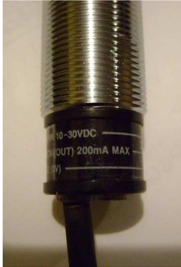
**Foto 3** Etiqueta de Especificaciones del Sensor Capacitivo
