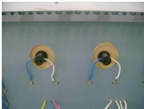
**Foto 6.17** Conexión de luces piloto (Parte posterior)
