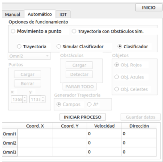
Interfaz HMI Modo Automático de Funcionamiento
