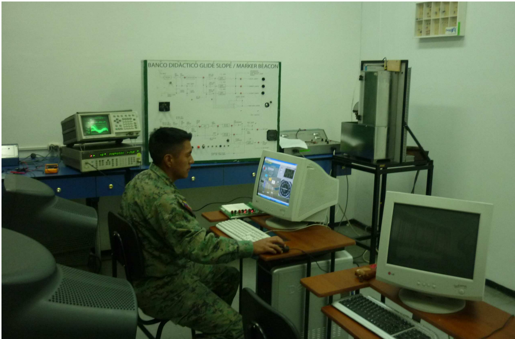
Fotografía 3.24 Operación del Módulo Didáctico Glide Slope desde el LabVIEW8.6
