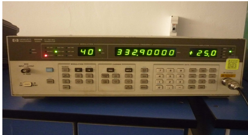
Fotografía 3.22 Generador de Señal con los parámetros seleccionados
