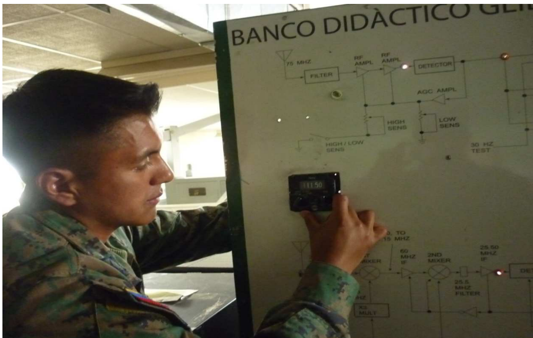
Fotografía 3.7 Instalación del Control VHF 313-4D en el Banco Didactico 2
