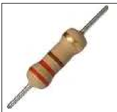
Fotografía 2.7 Resistencia de 240\Omega de la fuente +28VCC.
