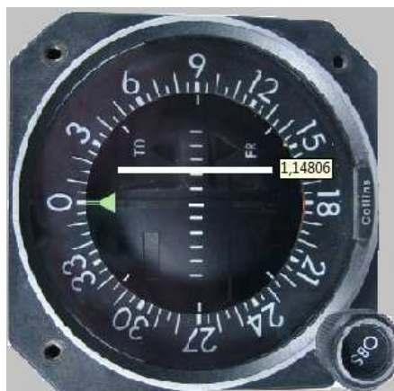
Figura 3.26 Indicador IND-350 listo para la simulación
