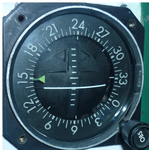
Fotografía 1.10 Indicador con 0.045% DDM hacia 90 Hz.
