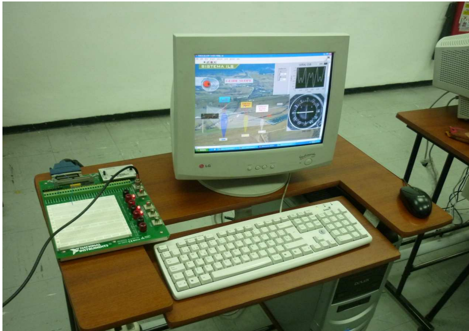
Fotografía 3.16 Comunicación entre el Software LabVIEW 8.6 y la tarjeta DAQ
