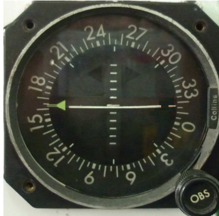
Fotografía 1.7 Indicador encendido con 0.00% DDM.
