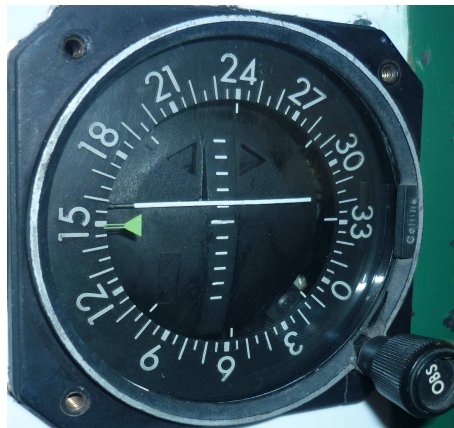
Fotografía 1.8 Indicador con 0.045% DDM hacia 150 Hz
