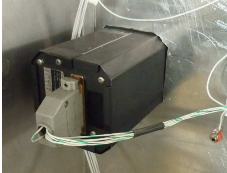
Fotografía 3.8 Entrada del conector al indicador IND-350
