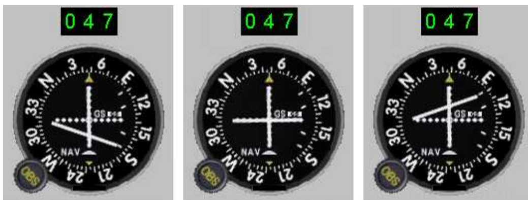
Figura 2.13 De izquierda a derecha, el avión está sobre, en y debajo de la trayectoria de deslizamiento
