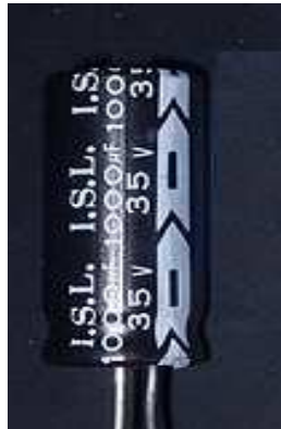
Fotografía 2.5 Condensador electrolítico de 1000 \mu f a 35 V.
