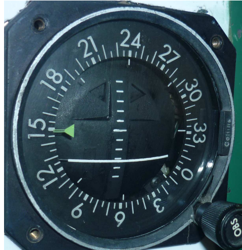
Fotografía 1.11 Indicador con 0.091% DDM hacia 90 Hz.
