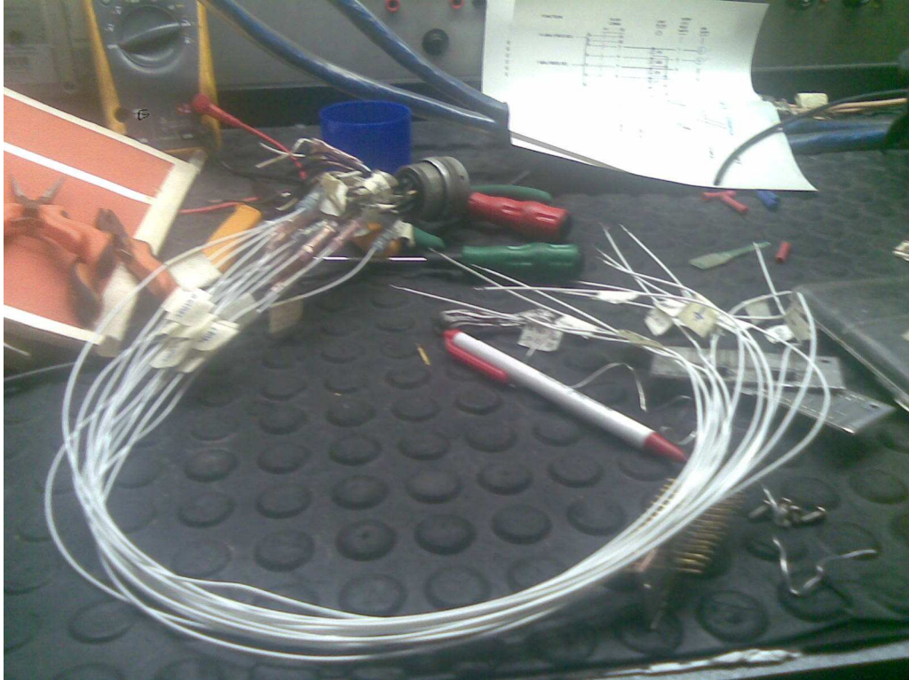
Fotografía 3.5 Conector del Control VHF 313-4D con sus pines de salida.
