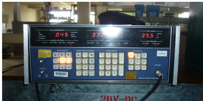
Fotografía 2.11 Generador de Señal VOR/ILS 479S-6A
