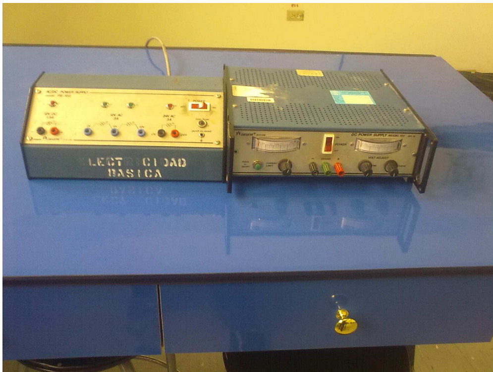
Fuentes de Alimentación AC/DC y DC Variable Fuente: Pablo Zambonino
