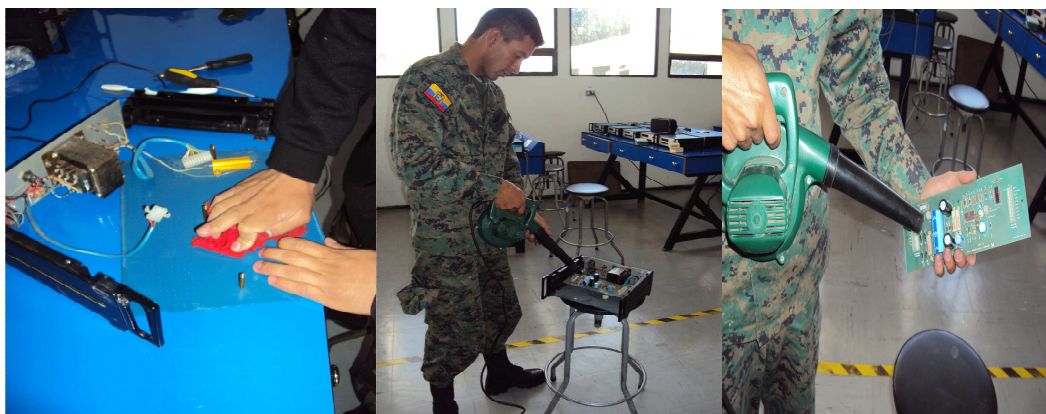
Foto.3. 1 Limpieza interna y externa de las fuentes DC Power Supply
