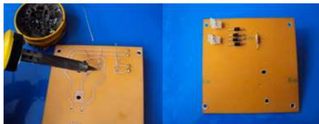
Foto.3.24 Montaje de los elementos electrónicos.
