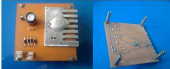
Foto.3.25 Montaje de elementos y colocación de soportes.
