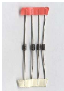
Fig.2.28 Representación de un Diodo Rectificador. Fuente: http://www.ladelec.com/teoria-diodos-rectificadores.html
