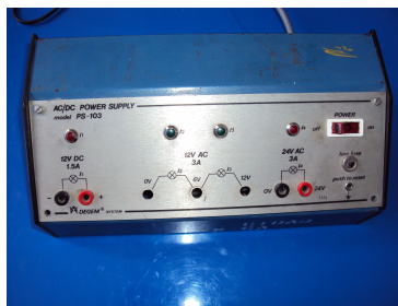
Foto.3. 3 Fuente con borneras en mal estado.
