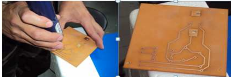
Foto.3.23 Perforación de la placa.
