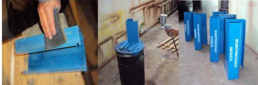
Foto.3.33 Lijada y pintada de las estructuras.
