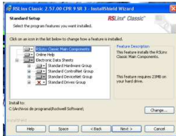
Figura 3.24: Cuarta ventana de proceso de instalación de RSLinx Classic. Fuente: Software RSLinx Classic.
