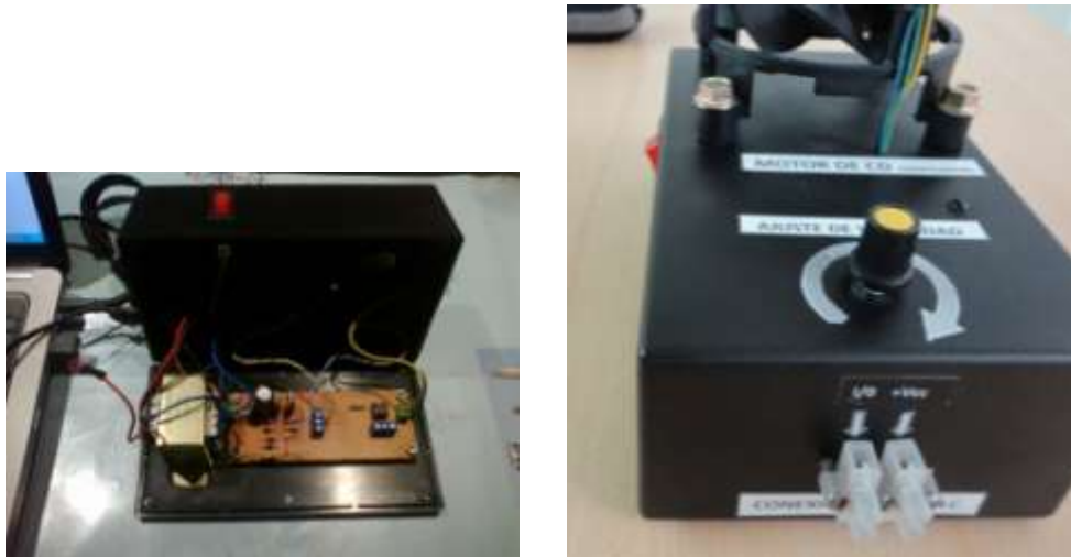
Fotografía 3.7: Montaje de placa electrónica y elementos en la caja de proyectos. Elaborado por: Díaz Gamboa Marco Antonio.
