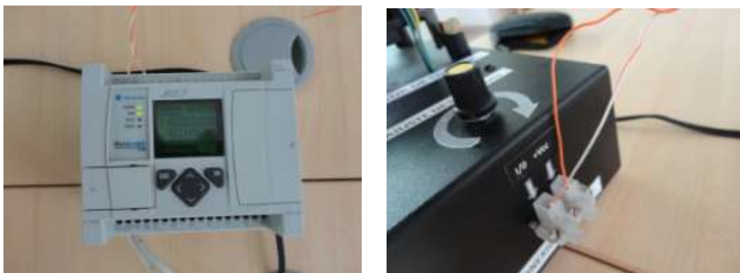
Fotografía 3.8: Vista de conexiones del PLC MicroLogix 1100 y el módulo del motor de DC. Elaborado por: Díaz Gamboa Marco Antonio.
