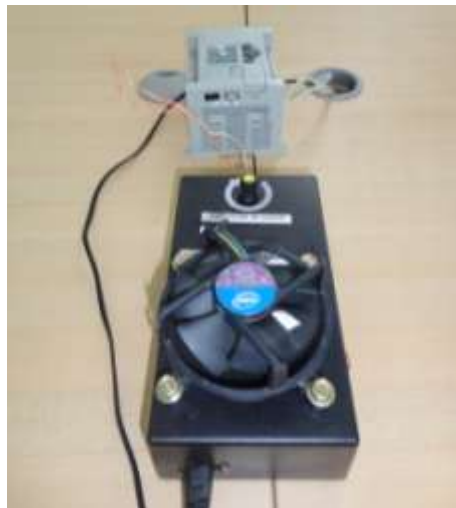
Fotografía 3.10: Conexiones entre el módulo del motor DC y el PLC MicroLogix 1100. Elaborado por: Díaz Gamboa Marco Antonio.
