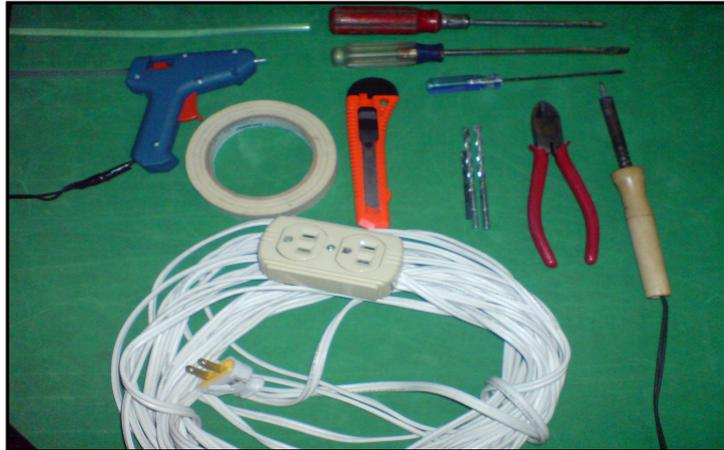
**Fuente:** Equipo utilizado en la implementación del sistema de seguridad.
