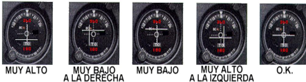
**Figura 2.19:** Principio básico del instrumento ILS
