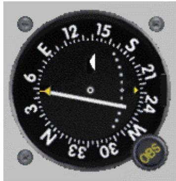
**Figura 2.34:** Indicador del Glide Slope
