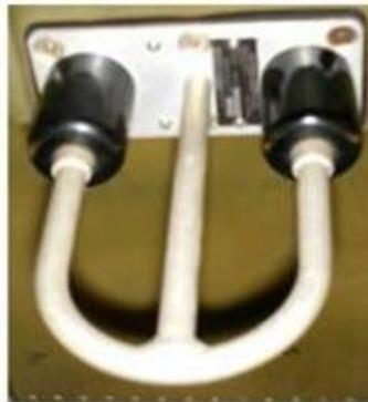
**Figura 2.31:** Antena Glide Slope del Avión C-130H
