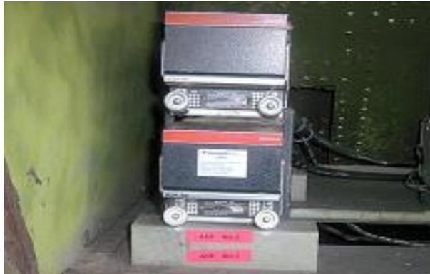
**Figura 2.3:** Equipo receptor ADF-60
