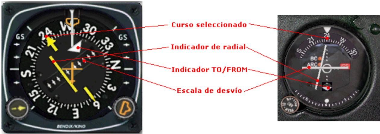
**Figura 2.14:** Instrumento en el avión
