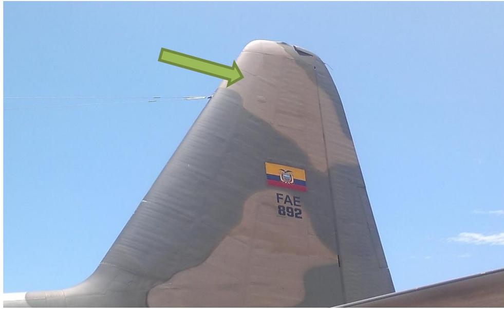
**Figura 2.21:** Antena del Localizador LOC
