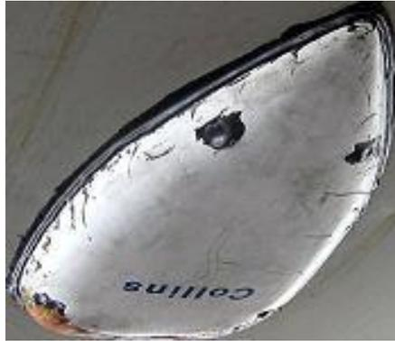
**Figura 2.8:** Antena de ADF Tipo: ANT-60
