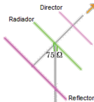
Figura 6: El esquema de una Antena Yagi simple.
