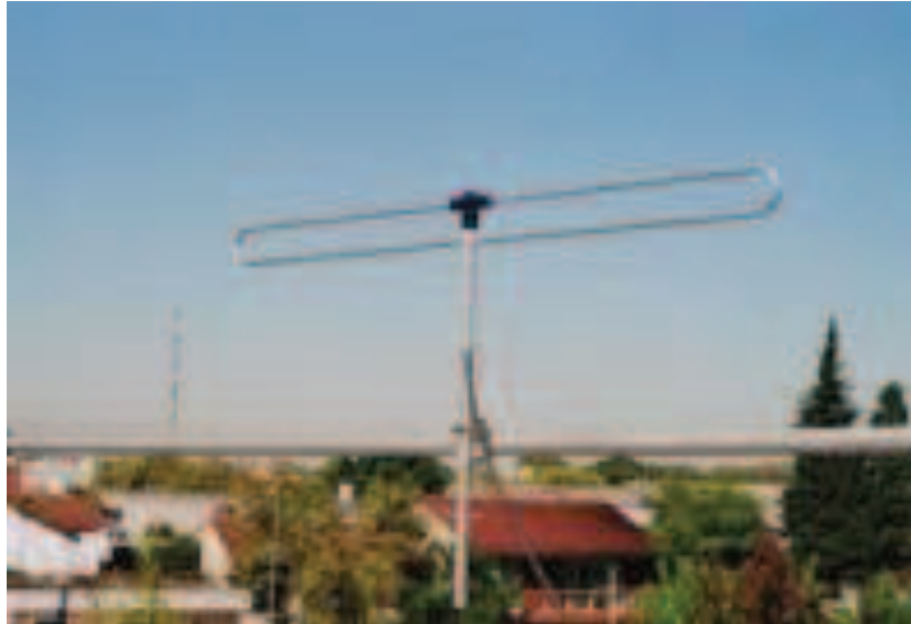
Figura 2.6 Dipolo en proceso de medición
