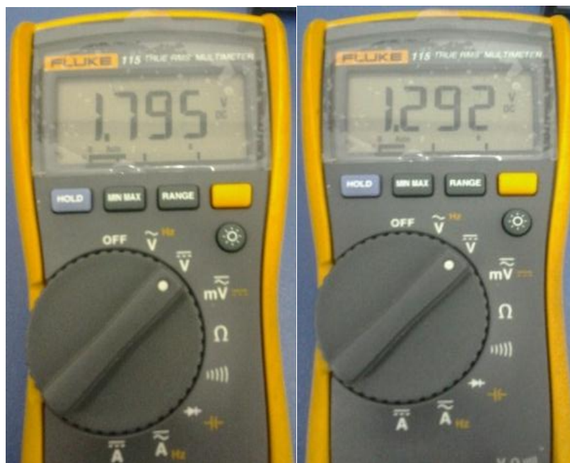
Foto 3.1 Visualización del voltaje correspondiente a Nivel y Temperatura
