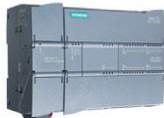
Figura 2.13 Representación del Módulo montado en el Simatic S7 1200
