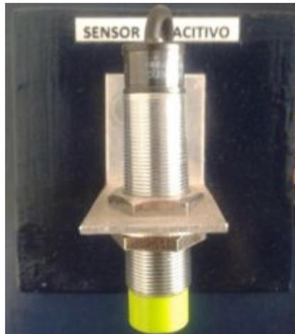
Figura 66: Sensor Capacitivo
