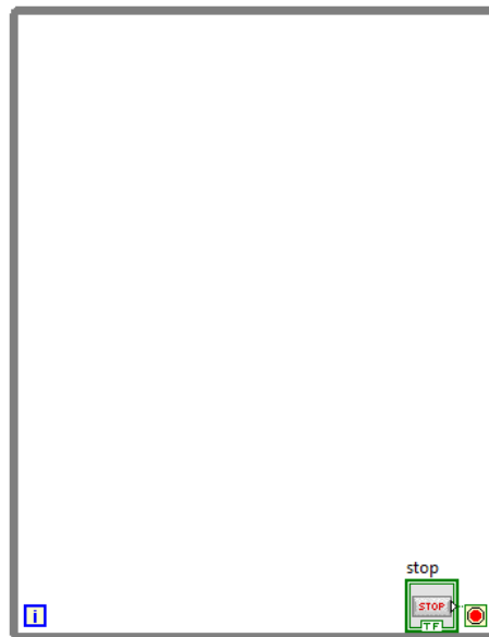
Figura 3.15. Estructura While Loop
