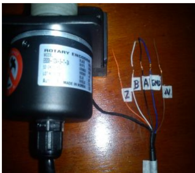
Foto 6. Cableado del Encoder Incremental
