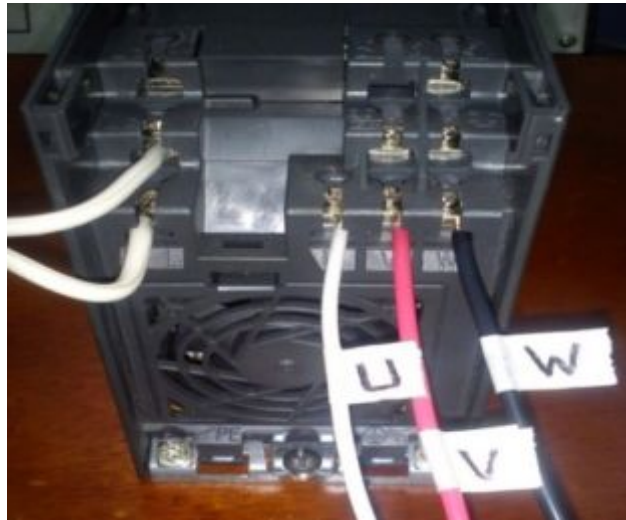
Foto 4. Conexiones físicas del MICROMASTER 440 Elaborado Por: Javier Padilla.
