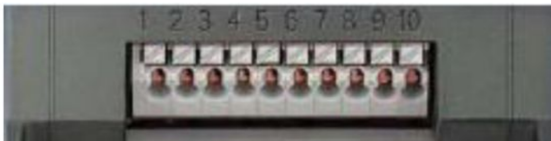
Figura 2.3. Bornera de Terminales del Variador de Frecuencia G 110
