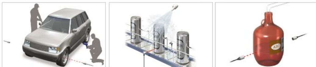
Figura 16: Aplicación del sensor Fotoeléctrico
