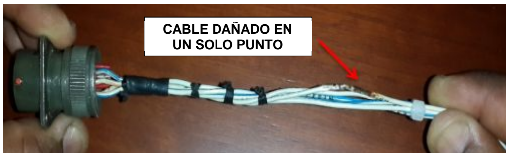
Figura 22: Evaluación de daño
