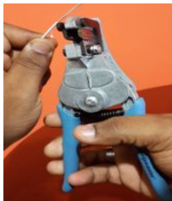
Figura 21: Cable despojado del aislamiento
