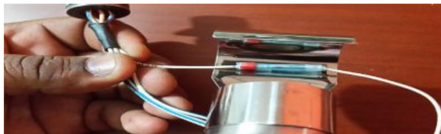
Figura 28: Sellado de la manga mediante la pistola de calor
