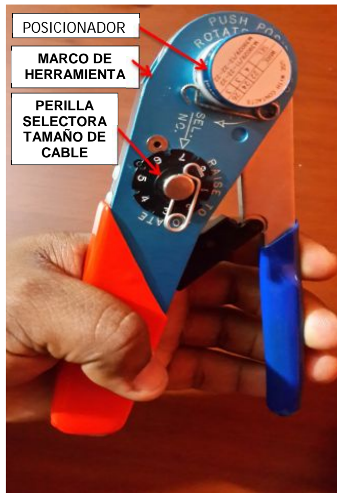
Figura 35: Herramienta básica crimp tool (ponchadora de contacto)
