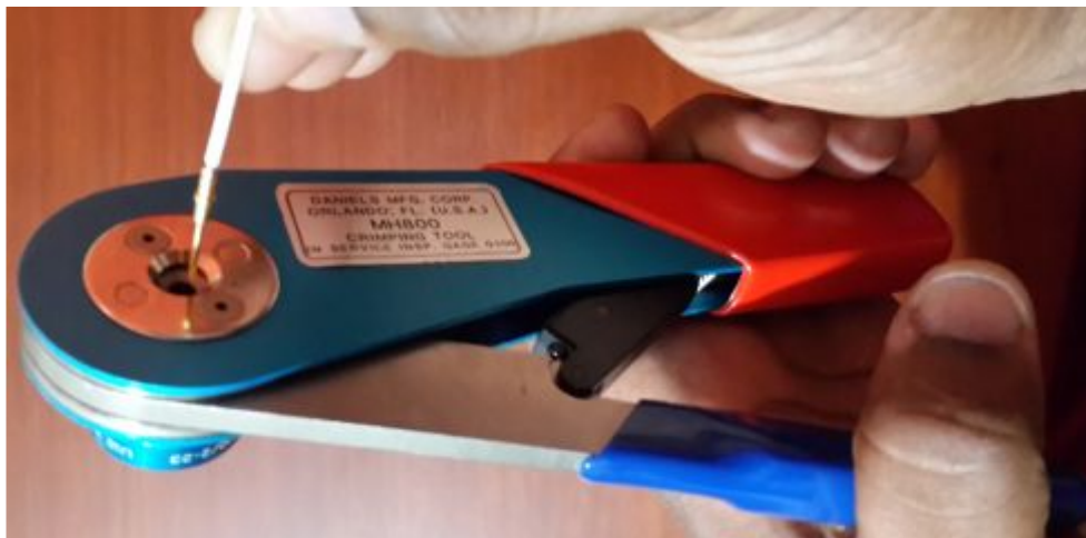
Figura 36: Montaje del cable en el contacto
