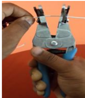
Figura 20: Despoje de aislamiento
