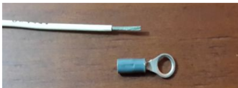
Figura 31: Cable sin aislamiento y terminal
