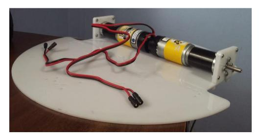
Nota: La figura indica como se une los motores con la base de la plataforma móvil.
