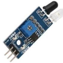
*Nota.* El sensor ya se encuentra acondicionado cuya exactitud debe ser regulada por medio de un potenciómetro, voltaje de operación 5 [V].
