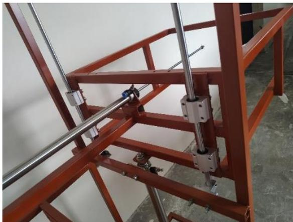
*Nota.* Rodamientos lineales SC10UU fijados a platina por junta empernada.
