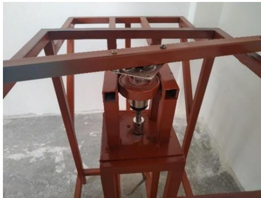
*Nota.* La sujeción del rodamiento M30 es por medio de un pasador de apriete a fin de mantener coaxialidad con los demás elementos además fijación de la base y brazo porta material.
