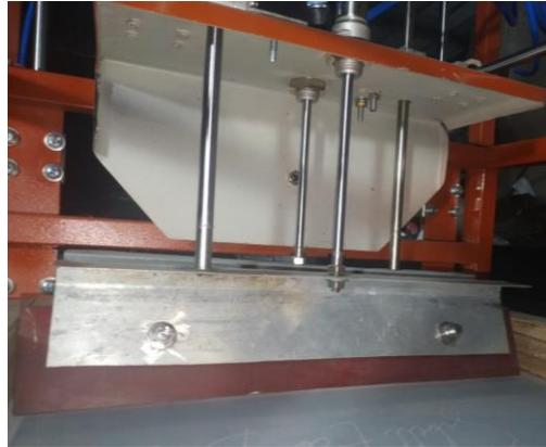
*Nota.* La altura de los rastrillos es regulable gracias a dos tuercas que se fijan a disposición del operador.
