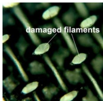
*Nota.* El daño más usual debido al uso de altas fuerzas de raseado es el desgaste de los filamentos del rastrillo debilitando los extremos de la tela y distorsionando la imagen impresa (Horvath, Torok, Ficzer, & Zador , 2014).
