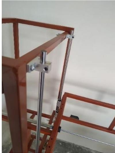
*Nota.* Ejes M10 verticales y soportes de aluminio con junta empernada.
