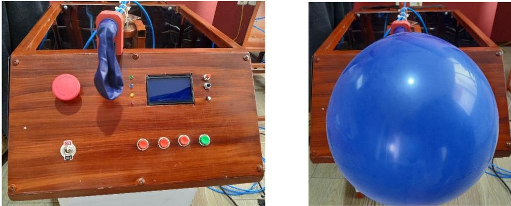
*Nota.* La medición corresponde al tiempo de inflado del globo hasta alcanzar el diámetro óptimo de impresión 70% del diámetro máximo.
