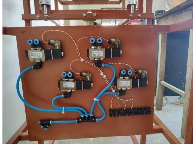
En cuanto a la sección de inflado de globos en la mesa de trabajo Figura 99 dichos componentes se encuentran en la parte interior de la mesa de trabajo y su función es la del inflado de globos, dado que solo son esquemas representativos estos son complementados con los esquemas de control y potencia presentes en la sección de planos Anexos.
