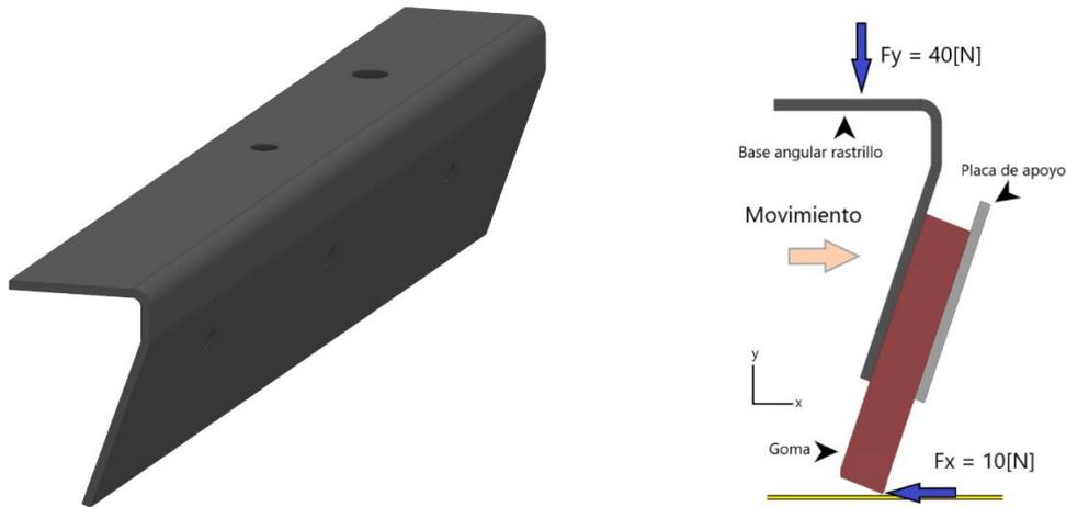
*Nota.* Diseño realizado en el software Autodesk Inventor 2021, a la derecha se muestra un esquema de los elementos que se acoplarán a la base angular y las fuerzas de raseado  $F_y$  y rozamiento  $F_x$ .
