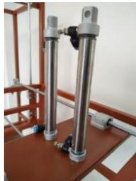
*Nota.* Los cilindros tienen una sección roscada externa M16 para sujetarlo con la chapa metálica con una tuerca.
