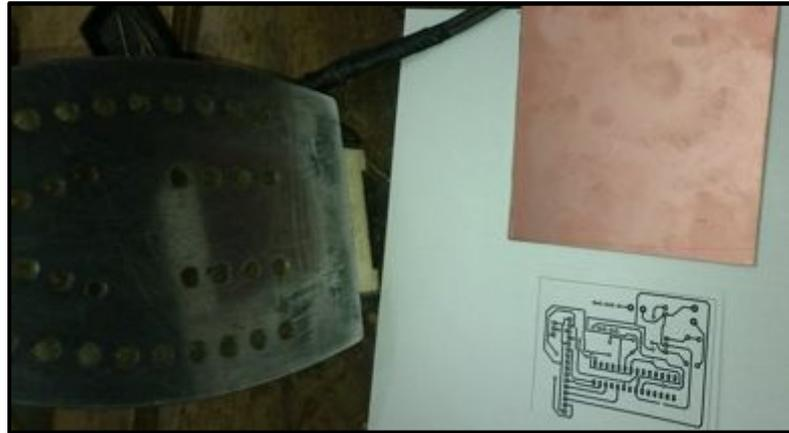
**Figura 25. Transferencia térmica del circuito a la placa de cobre.**
