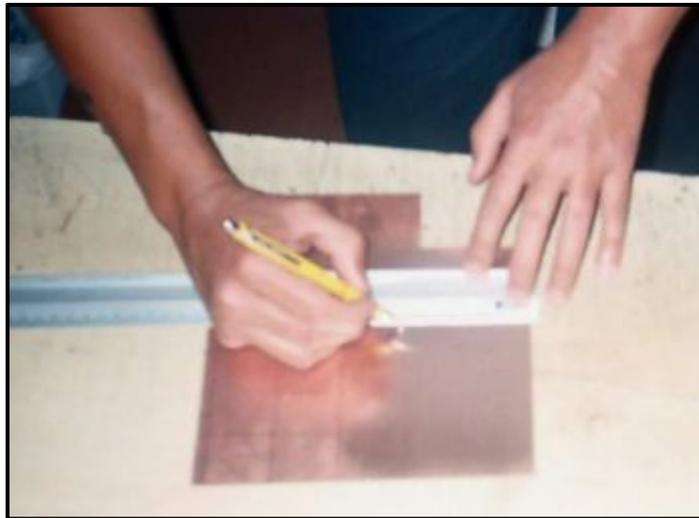
**Figura 23. Marcado del contorno de la placa.**
