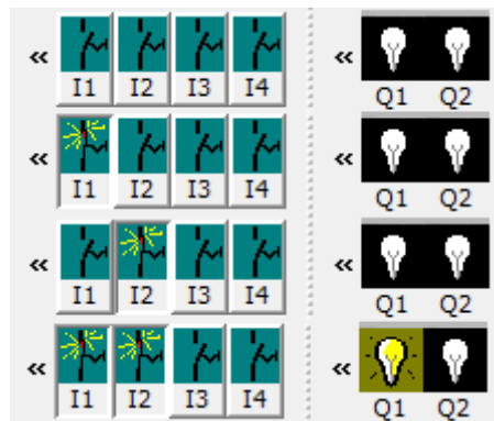
Figura 72. Comprobación parámetros AND
