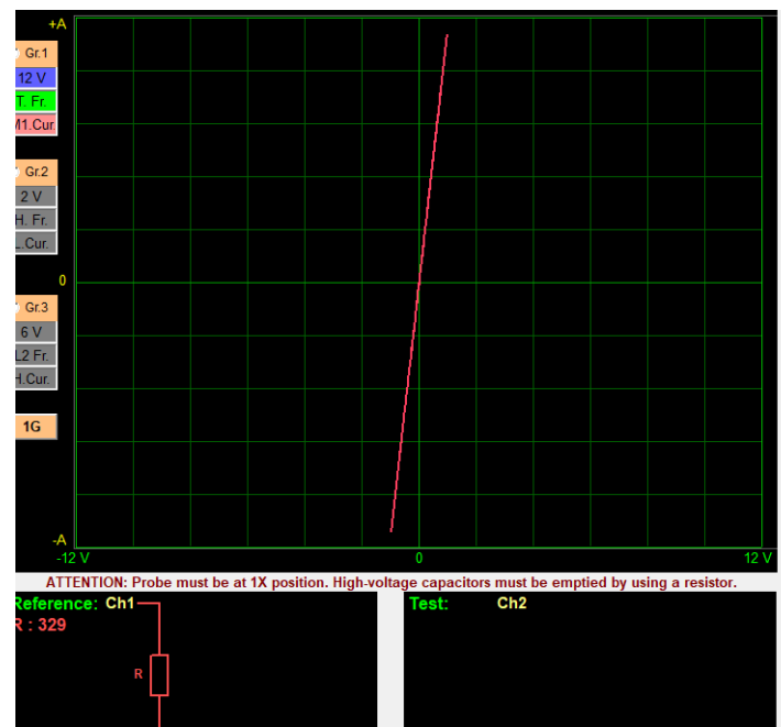
Figura 6 Firma de la resistencia
