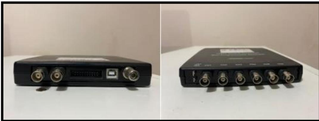
El osciloscopio automotriz Hantek 1008C tiene su propio software para realizar varios diagnósticos y pruebas. Con la ayuda de este equipo se puede realizar diagnósticos por imágenes con la ayuda de un trazador de imágenes que se puede construir manualmente.
