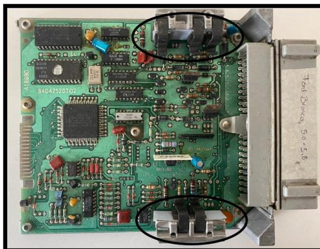
*Nota.* En la figura se encuentra señalado el circuito drivers de la ECU de un Ford Bronco.
