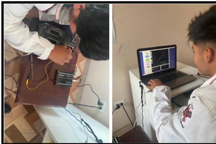
*Nota.* En la presente imagen se observa la conexión de pines de la ECU con los conectores de diagnóstico del osciloscopio multifuncional (FADOS9F1) y la imagen obtenida en el software del equipo.
