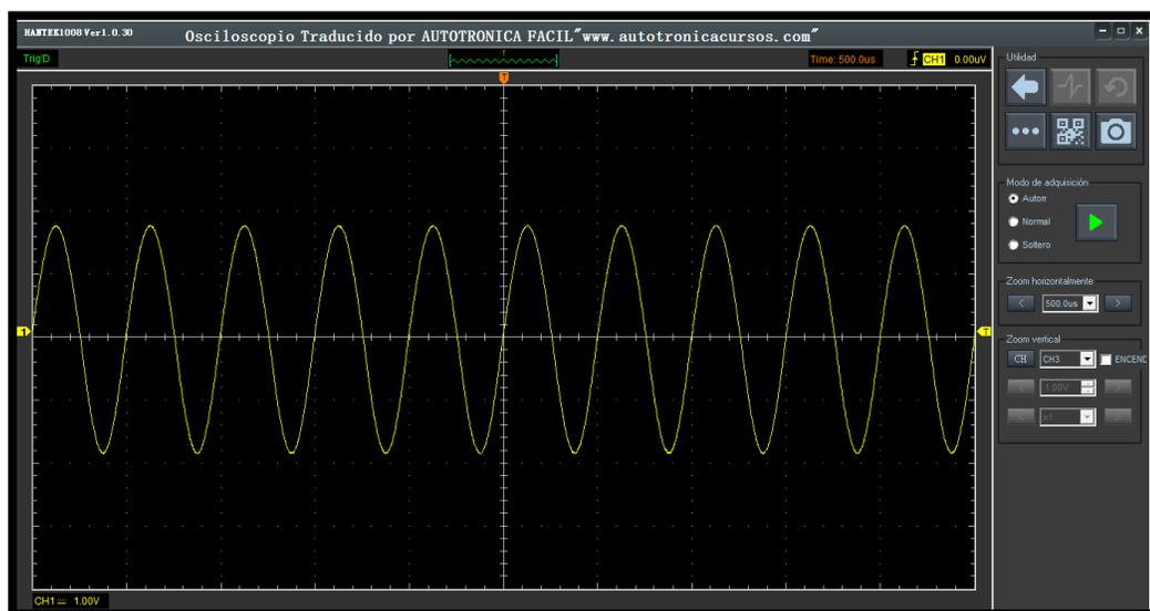
*Nota.* Señal analógica generada con un osciloscopio Hantek 1008C.
