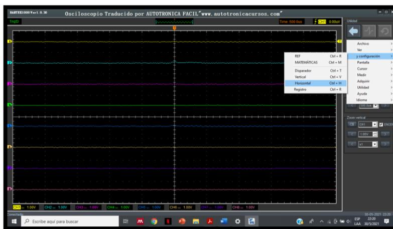
Se abrirá una pestaña de la configuración horizontal de osciloscopio, en el formato seleccionar el modo X-Y y los canales que va utilizar para generar las imágenes.
