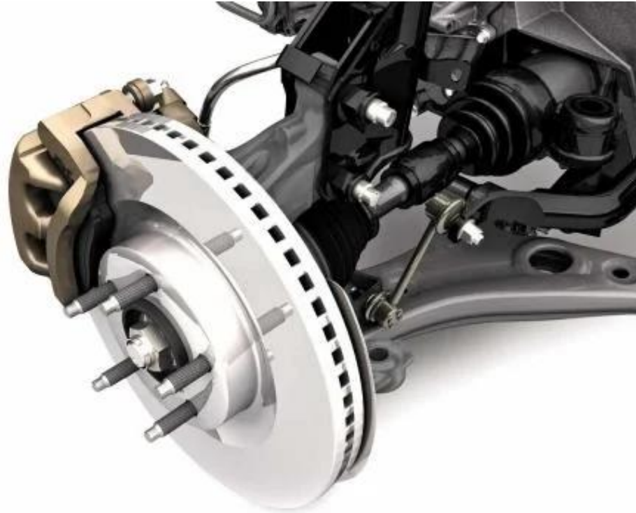
Figura 8 Sistema de freno de disco y pastilla
