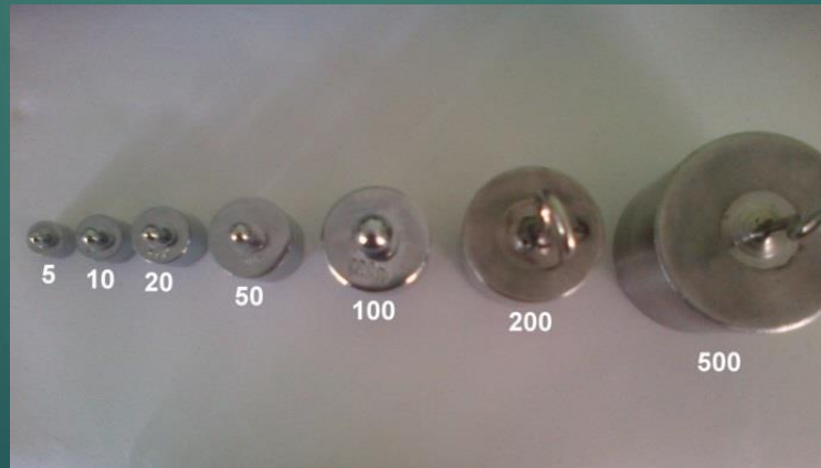
Figura 3. Pesas para para la comprobación de la celda de carga.
