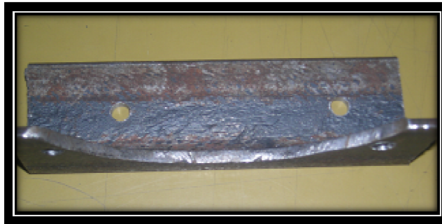
Fig. 6.15 Bases para los generadores.
