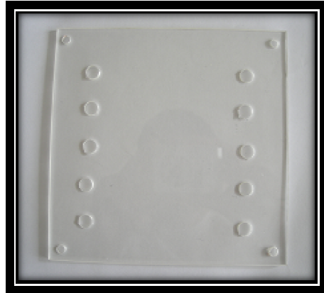
Fig.6.13 Placa de acrílico para el bloque de resistencias.
