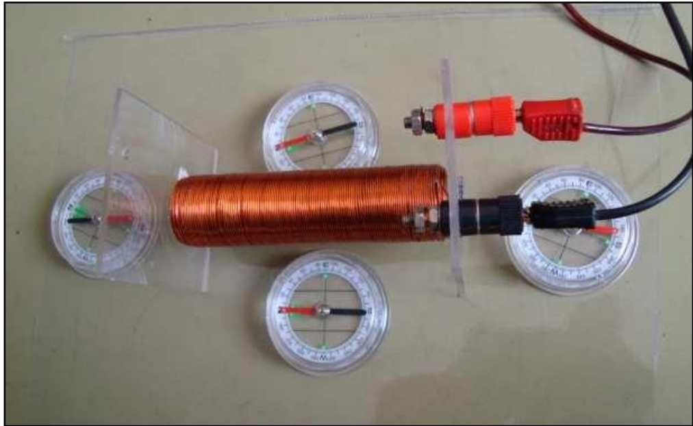
Foto 6.18 Campo magnético producido por un electroimán
