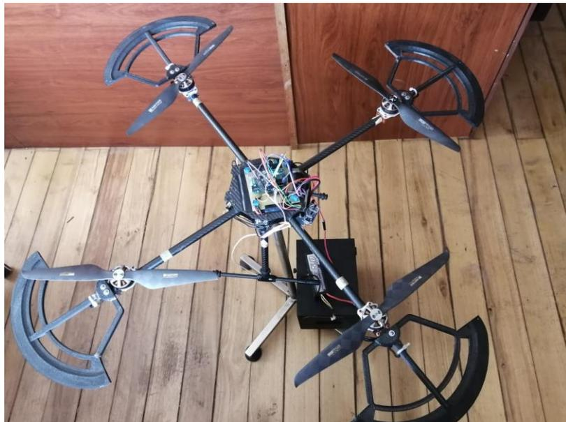
*Nota:* Se visualiza el controlador, sensores y ESCs ubicados en la parte superior del centro del cuadricóptero.
