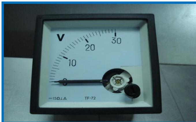
**Foto 6.1 Voltímetro analógico**
