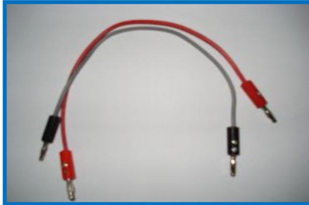
**Foto 6.18 Construcción de cables para las conexiones**
