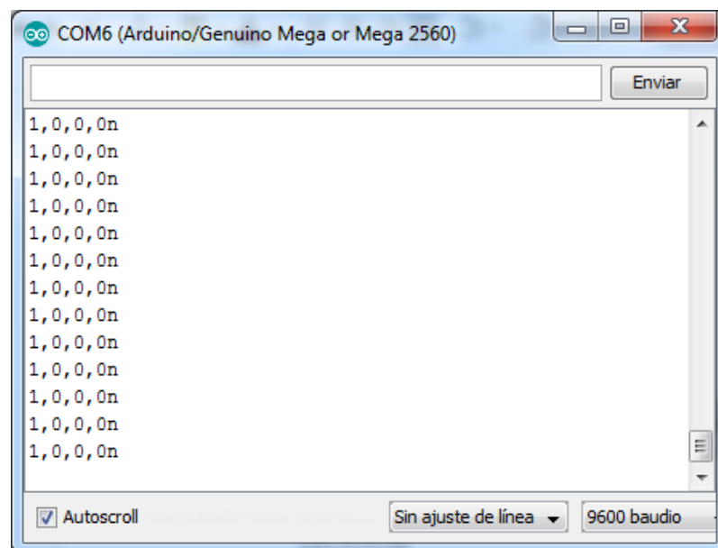
Figura 75 VP activado, C1, C2, C3 apagados.
