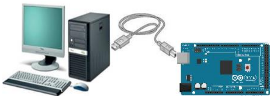
Figura 54 Conexión USB entre la tarjeta Arduino Mega y la PC.
