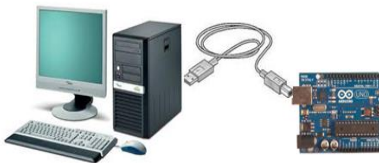
Figura 59 Conexión USB entre la tarjeta Arduino Uno y la PC.
