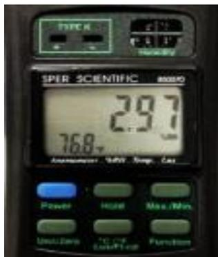
En la Figura 42, se realiza la medición del ventilador con un resultado de  $2.9 \frac{m}{s}$ , dando como resultado que el ambiente al interior de la cámara es convectivo y de flujo forzado.
