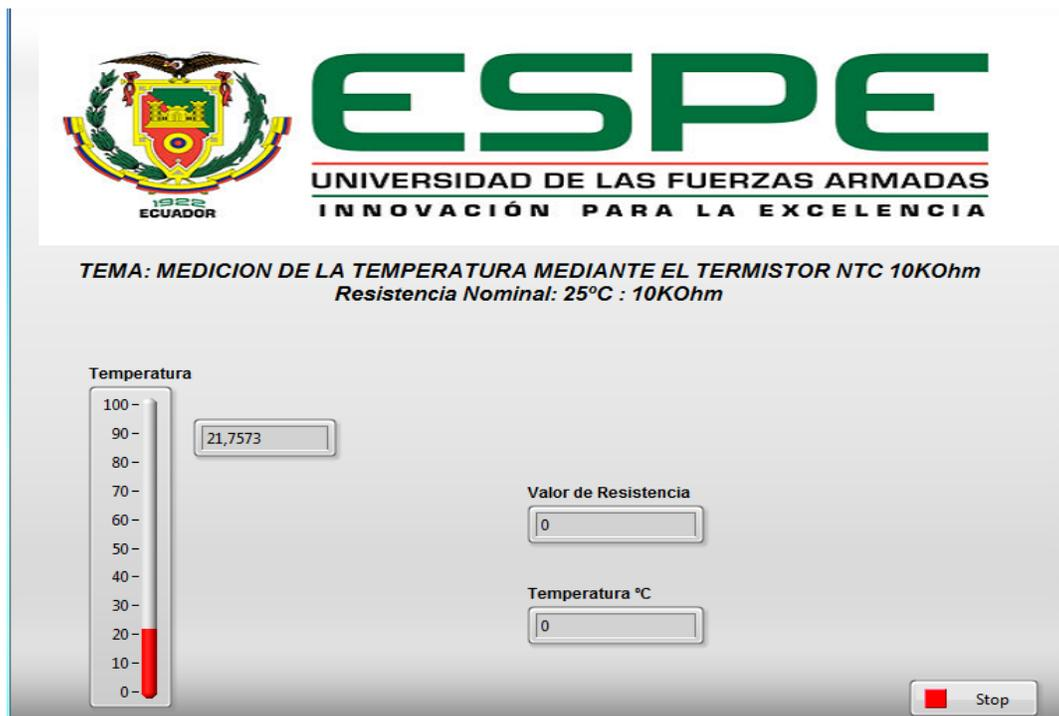
**Figura 48** Interface para la adquisición de señales del termistor
