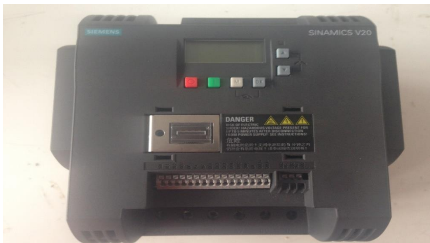
Figura 28 Variador V20 Siemens.
