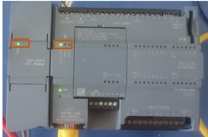
Figura 43 Comunicación establecida entre maestro AS-i y PLC.
