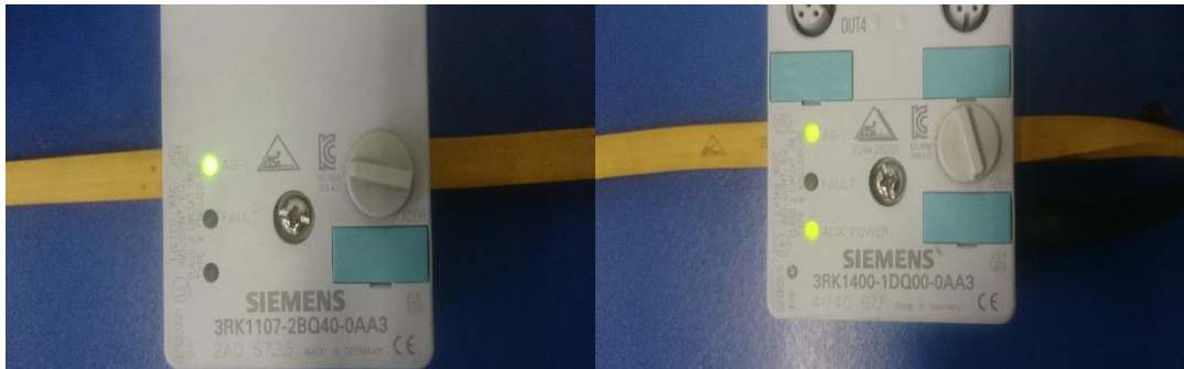
Figura 47 Esclavos Analógico y Digital, sin error y conectados a la red.
