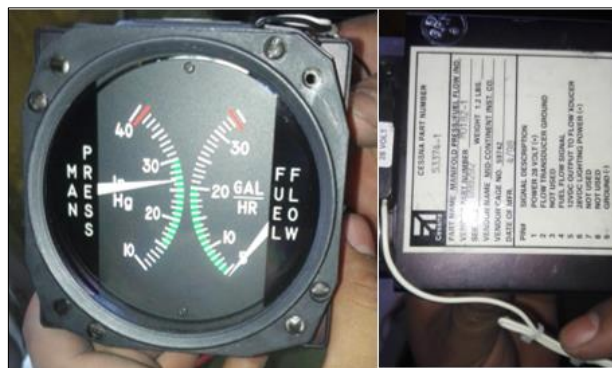
Figura 90 Identificación del Instrumento MANIFOLD INDICATOR/FUEL FLOW INDICATING
