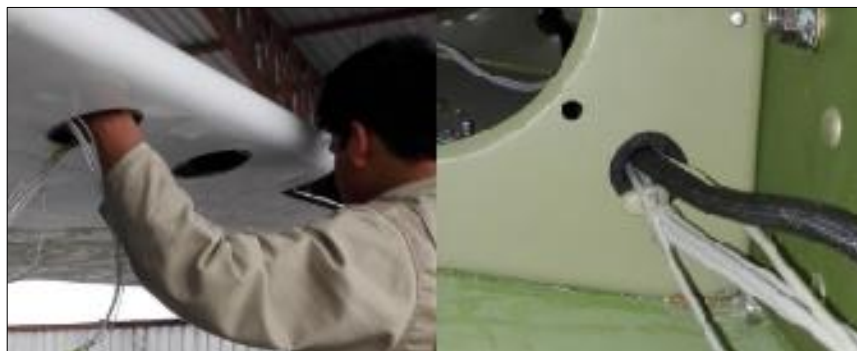
Figura 20 Instalación adecuada del arnés de cables.
