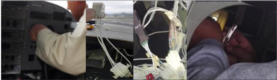
Figura 32 Identificación del conector del ELT dentro de la cabina.
