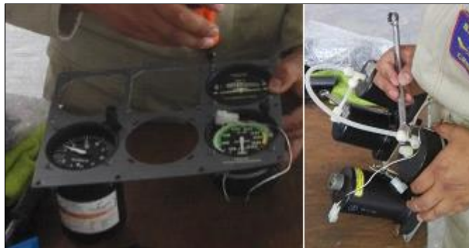
Figura 57 Colocación del altímetro en el panel de la aeronave.
