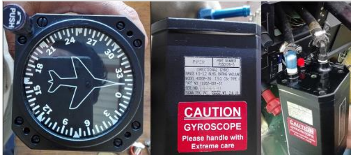
Figura 63 Instalación de FITINGS y CONDUCTOS de presión en el instrumento.
