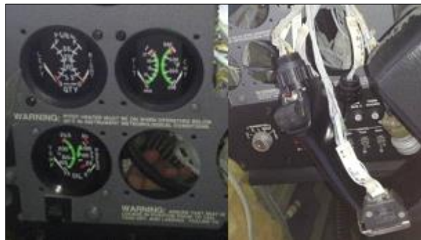
Figura 29 Reconocimiento e instalación del OIL TEMPERATURE/PRESSURE TEMPERATURE INDICATING en el panel de la cabina.
