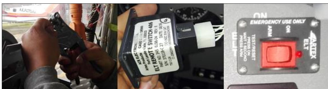
Figura 37 Instalación y ubicación del switch en el panel de la aeronave.
