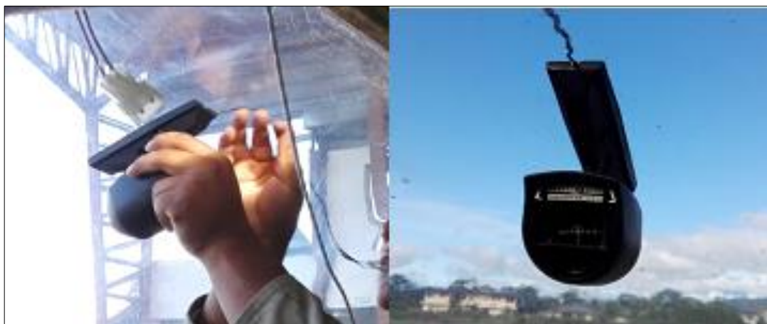
Figura 67 Instalación de la brújula dentro de la cabina de la aeronave.
