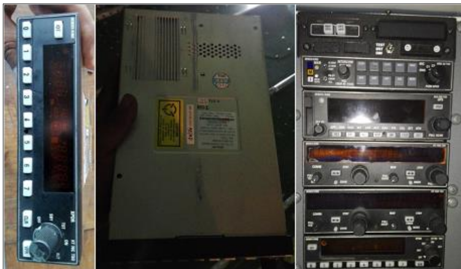
Figura 43 Instalación del equipo TRANSPONDER en el panel de la aeronave.
