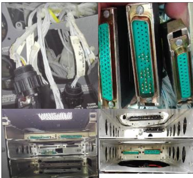
Figura 18 Verificación del estado de los conectores de los equipos e instrumentos de la aeronave CESSNA T206H.
