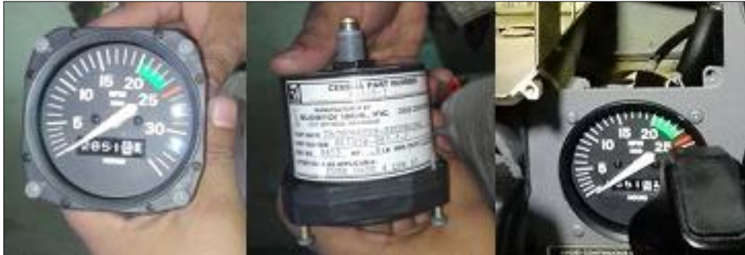
Figura 83 Reconocimiento del instrumento e instalación en el panel de la aeronave.
