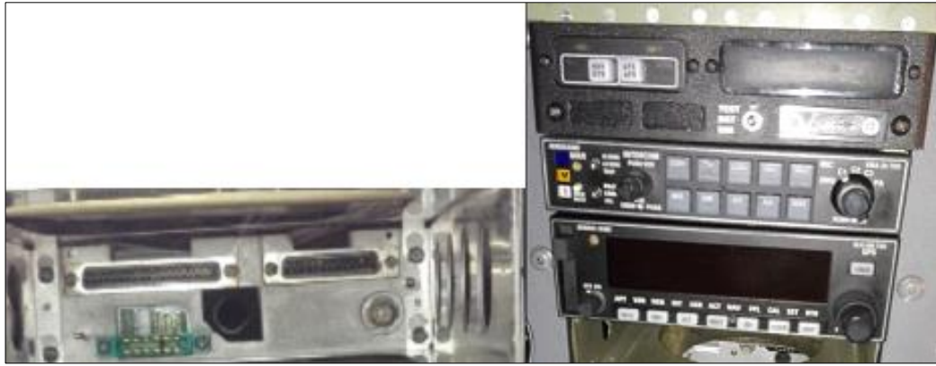
Figura 39 Revisión del conector e instalación del equipo en el panel de la aeronave.
