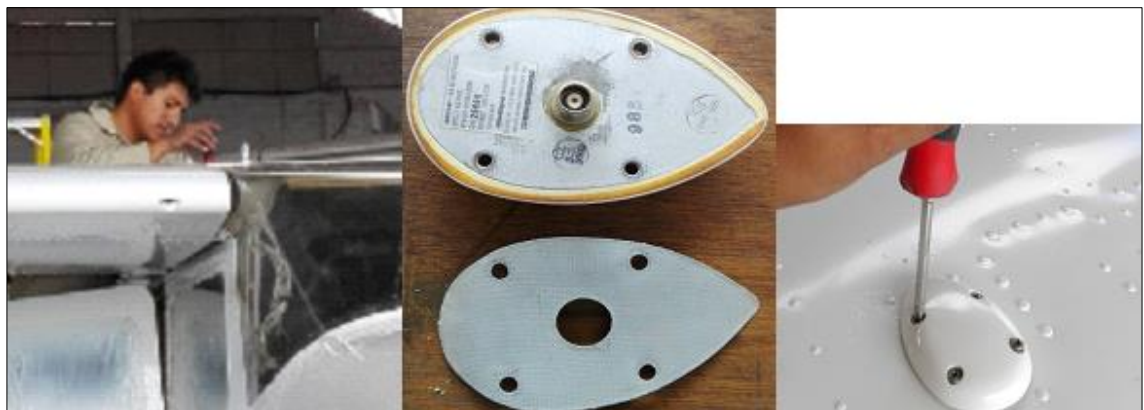
Figura 40 Colocación de la antena del GPS en la aeronave.
