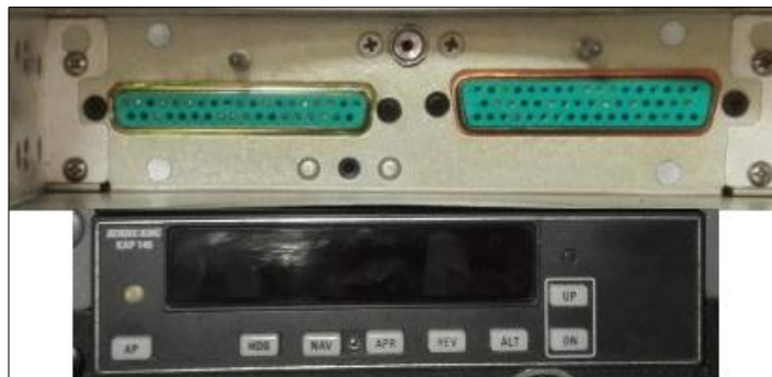
Figura 55 Verificación del conector y colocación del equipo AUTOPILOT CONTROLLER.
