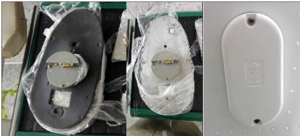
Figura 79 Reconocimiento e instalación de la antena en la aeronave.
