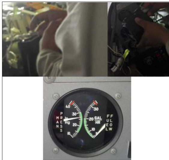
Figura 92 Instalación del MANIFOLD INDICATOR/FUEL FLOW INDICATING en el panel dentro de la cabina de la aeronave.
