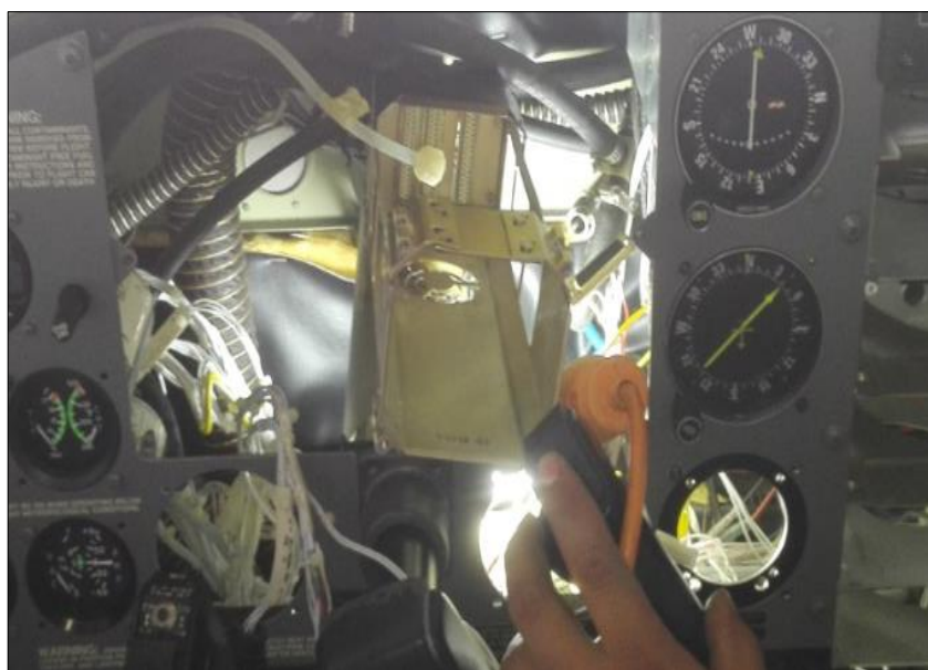
Figura 76 Instalación del KI-208 en el panel de la aeronave.
