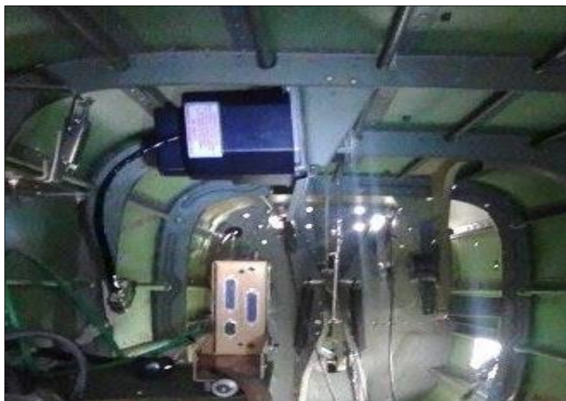
Figura 50 Colocación de las piezas móviles de AUTO PILOT.
