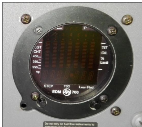
Figura 88 Instalación del JP INSTRUMENT en el panel de la aeronave.
