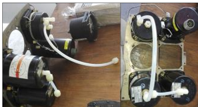
Figura 58 Instalación de mangueras en el instrumento.
