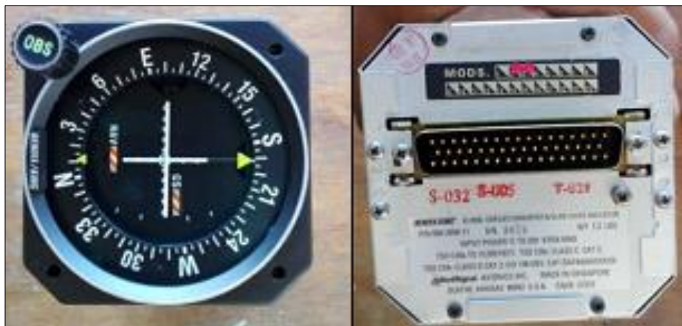
Figura 71 Análisis del estado del conector del KI-209A
