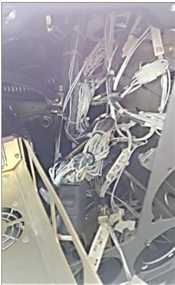
Figura 75 Verificación del estado del conector del instrumento KI-208.
