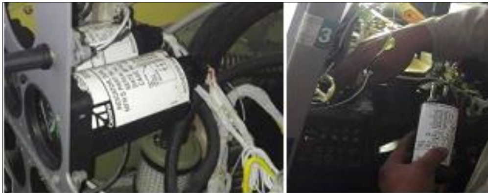
Figura 31 Instalación del TIT/CHT con su respectivo conector eléctrico.
