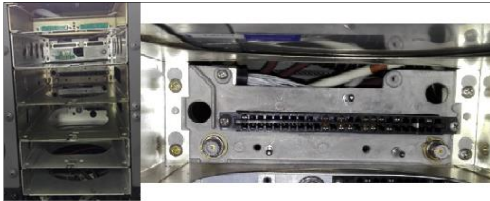
Figura 46 Indicación de la caja del equipo y conectores para NAV/COM RADIO de la aeronave.
