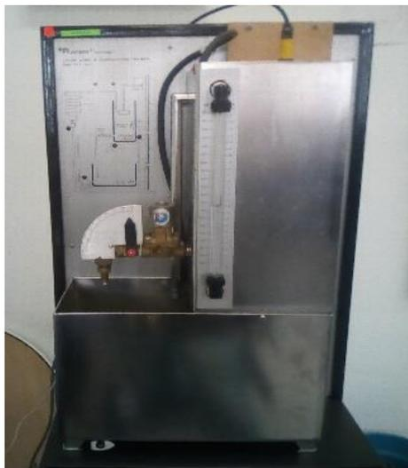
**Fotografía 1 Estación de Nivel (tanque, electroválvula, sensor)**
