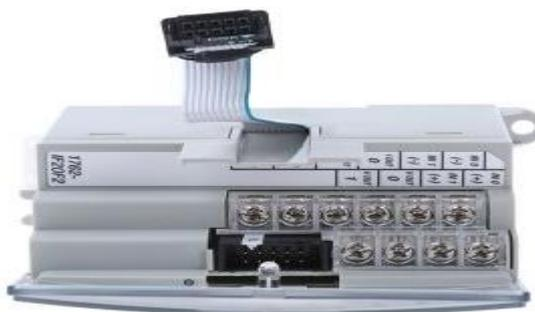
**Figura 14 Módulo de expansión de entradas analógicas**
